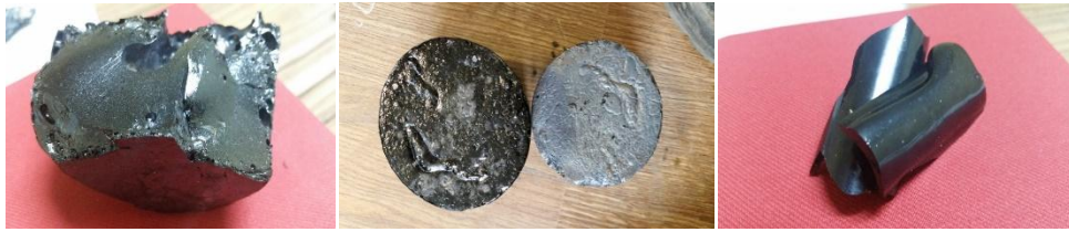
Görsel 3.3. XRF yöntemi ile analizi yapılan farklı cüruf türleri
