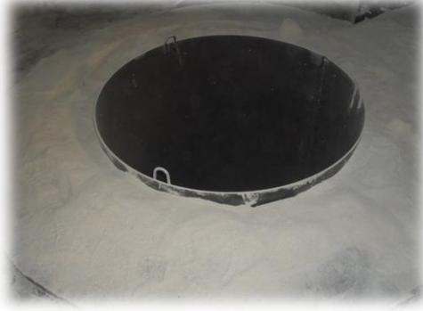
Görsel 2.9. Şablon kenarlarının astar malzemesi ile doldurulduktan sonraki görüntüsü
