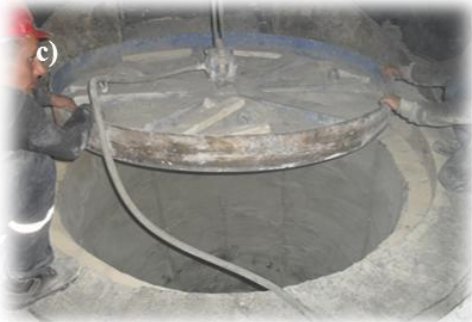
Görsel 2.6. İndüksiyon ocağının taban astarlaması
