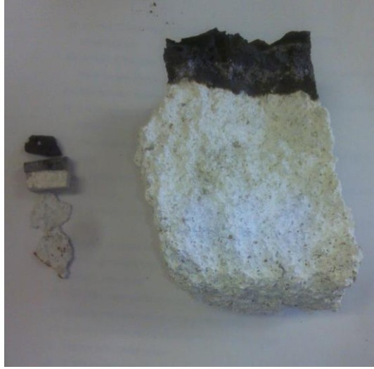
Görsel 3.2. Söküm astarı için XRD numuneleri
