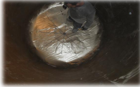
Görsel 2.5. İndüksiyon ocağının tabanına yerleştirilmiş topraklama çubuğu
