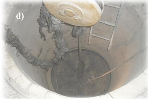
Görsel 2.6. İndüksiyon ocağının taban astarlaması
