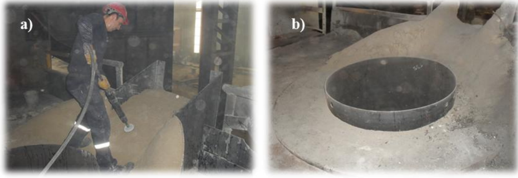
Görsel 2.11. İndüksiyon ocağının a) yolluk yapımı, b) üretime hazır hali
