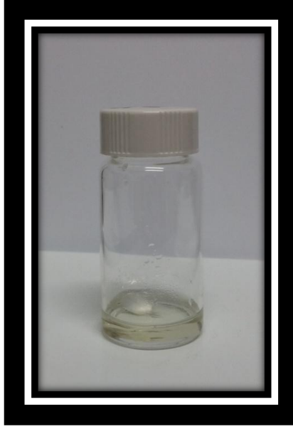
Görsel 5.3. KL'nin Stearik asit'deki çözünürlük denemesi
