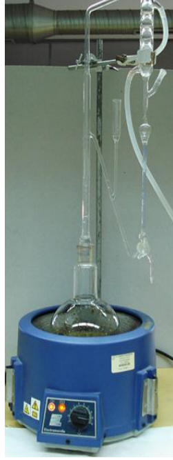
Şekil 8. Clevenger Aparentinde Hidrodistilasyon İşlemi
