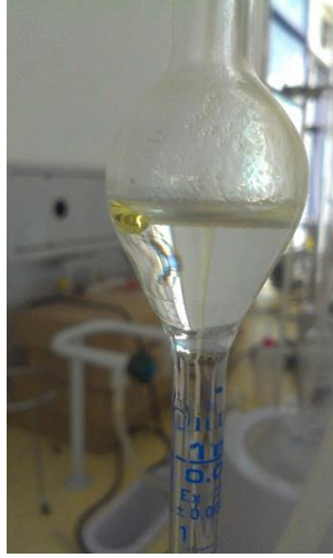
Şekil 17. T. haussknechtii Bitkisinden Clevenger Apareyinde Uçucu Yağın Elde Edilmesi
