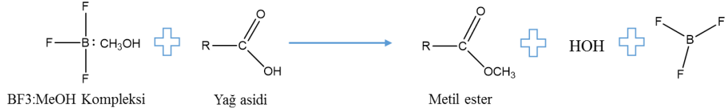
Şekil 8. Boron triflorür Reaktifi ile Yağ Asitlerinin Metil Esterlere Dönüşme Reaksiyonu
