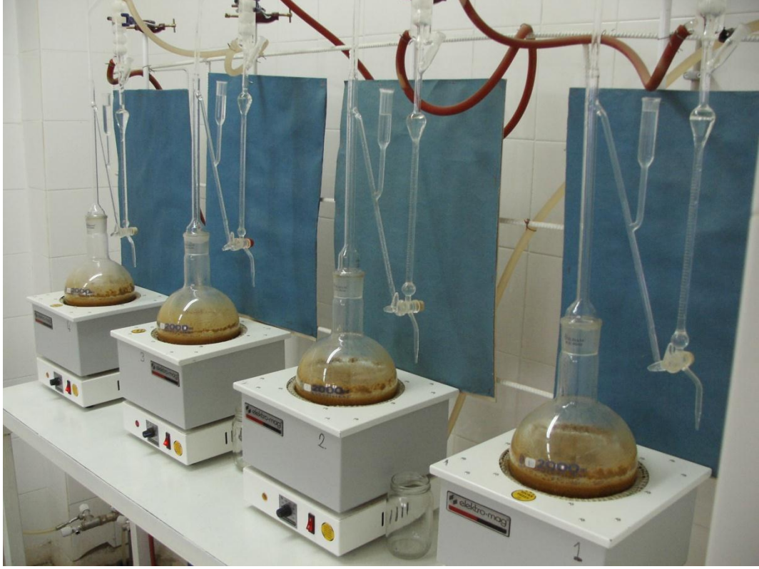
Şekil 8. Clevenger Aparentleri ve Uçucu Yağ Eldesi İşlemi
