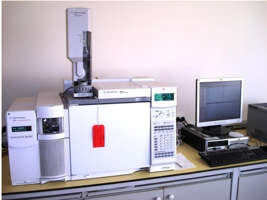
Şekil 7. Gaz kromatografisi/Kütle spektrometrisi (GK/KS)
