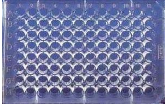
Şekil 11. Mikrodilüsyon Tekniğinde Kullanılan 96 (well) Kuyucuklu Mikrotitrasyon Petrisi
