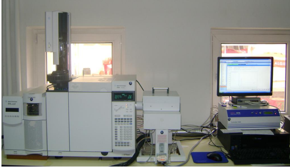
Şekil 9. Gaz kromatografisi/Preparatif Fraksiyon Toplayıcı (GK/PFT)
