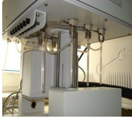
Şekil 8. Preparatif Fraksiyon Toplayıcı (Gerstel)
