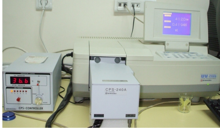
Şekil 7. Antioksidan Aktivite Çalışmalarında Kullanılan UV-VIS Spektrofotometre
