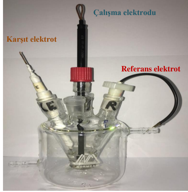
Şekil 2.6. Voltametric ölçümlerde kullanılan hücre ve hücre bileşenleri.
