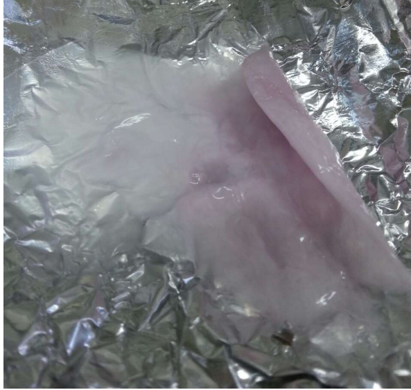
Şekil 4.6. Nanofiber üzerinden uzaklaştırılamayan altın nanopartiküller
