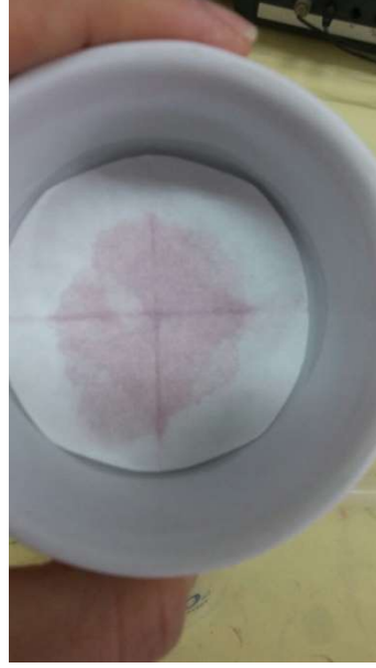
Şekil 4.7. Nitroselüloz tabakadan uzaklaştırılamayan nanopartiküller
