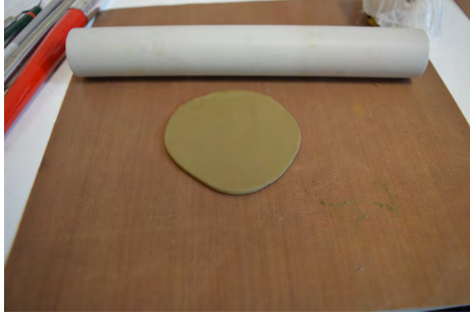
Görsel 4.4. Metal kilinin şekillendirilmesi (Yeşilmen, 2018)
