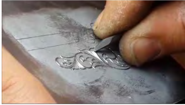
Görsel 2.30. Çelik kalemlerle oyma yöntemi ( https://www.youtube.com/watch?v=EmaJbXwUvtM ) Erişim Tarihi: 05.02.2018
