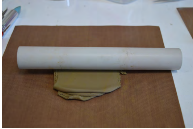
Görsel 4.3. Nemini kaybetmiş metal kilinin plastik hale getirilmesi (Yeşilmen, 2018)
