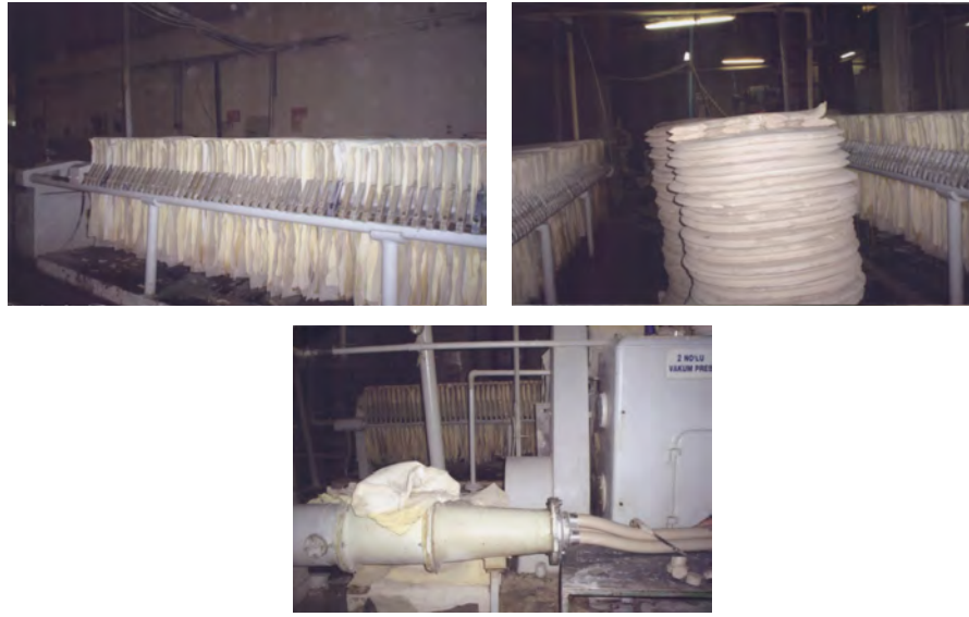
Görsel 1.2. Plastik çamur hazırlama Kaynak: Fotoğraf: Emel Şölenay
