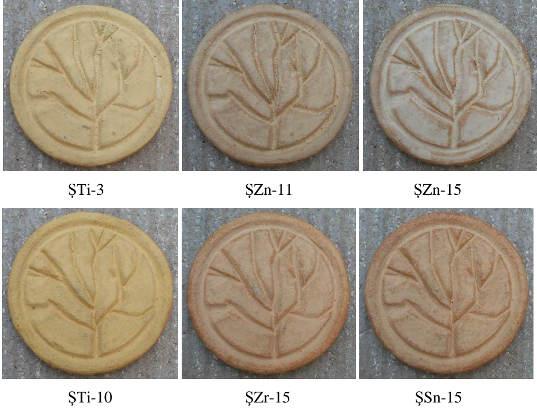
Görsel 3.11. Şamot bünye üzerinde astarlı sırsız pişirim sonuçları (1160 °C)
