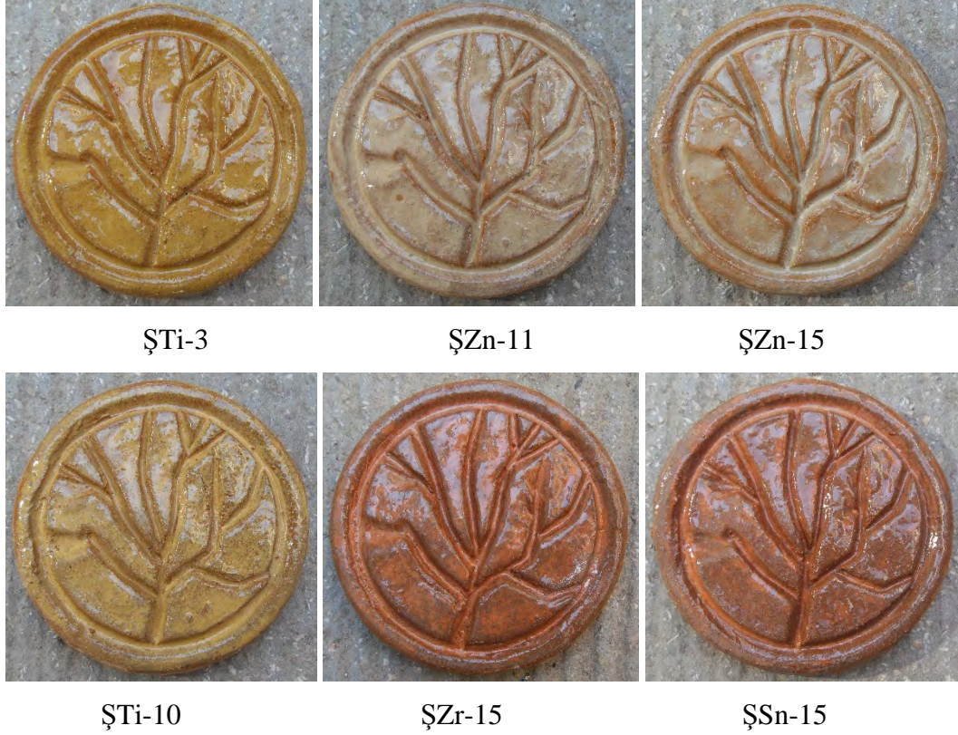
Görsel 3.12. Şamot bünye üzerinde astarlı sırlı pişirim sonuçları (1160 °C) Kaynak: Fotoğraf: Ali Cihan Kayalıoğlu
