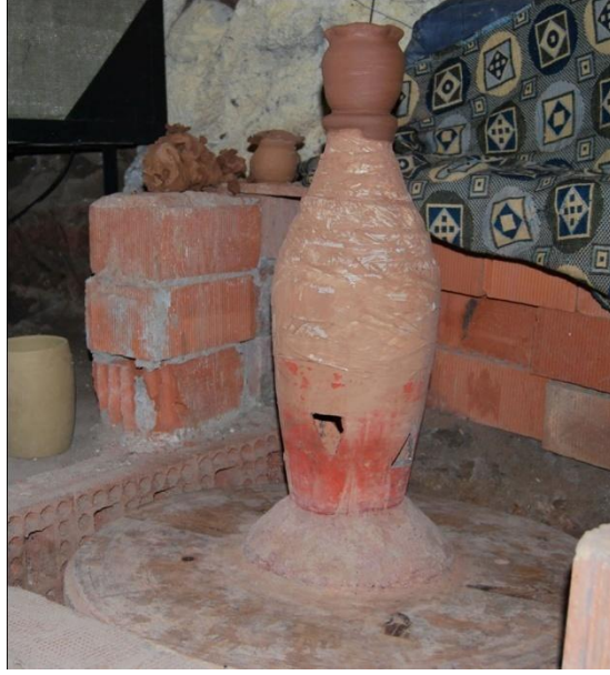
Resim 28: Nevşehir ili Avanos İlçesinde Kullanılan Tepme Tezgâh Fotoğraf: Ayşe Canbolat, Temmuz 2009.
