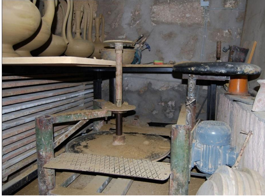
Resim 39: Nevşehir İli Avanos İlçesinde Kullanılan Elektrikli Torna, Erdem İbaş Atölyesi, Temmuz 2009.
