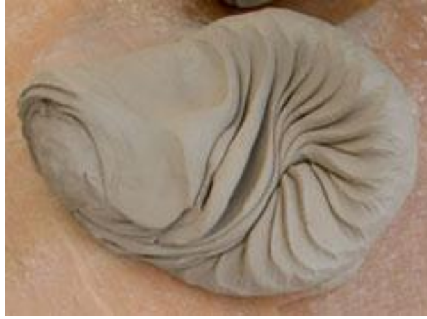
Resim 45: Krizantem veya Spiral Çamur Yoğurma Yöntemi ile Yoğrulmuş Çamur Kütlesi, Fotoğraf: Ayşe Canbolat, Mayıs 2009.
