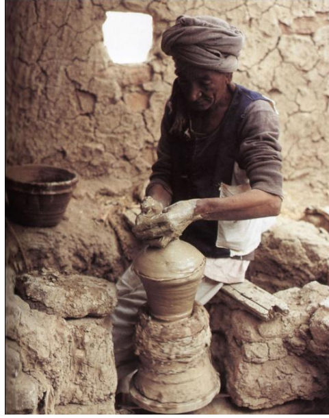
Resim 21: Mısır-Luxor yakınlarında ayak tornasında şekillendirme 1990, (Emmanuel Cooper, Ten Thousand Years of Pottery , 4th Edition, Philadelphia University of Pennsylvania, 2000, s. 203.)
