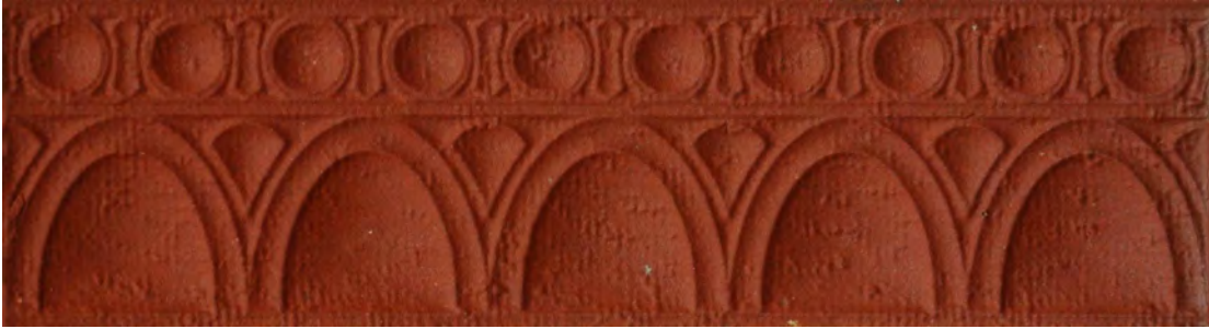
Resim 89. Fe 2 O 3 Katkılı Bünyelerin Sırsız Pişme Renkleri, 1200°C
