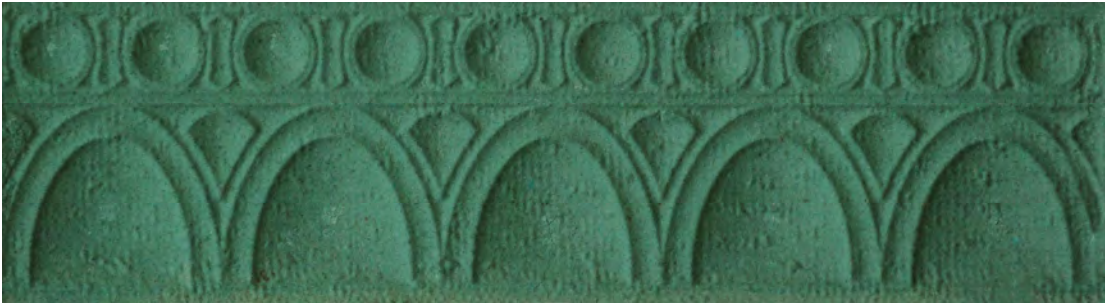
Resim 109. Mavi-Yeşil Boya Katkılı Bünyelerin Sırsız Pişme Renkleri, 1200°C
