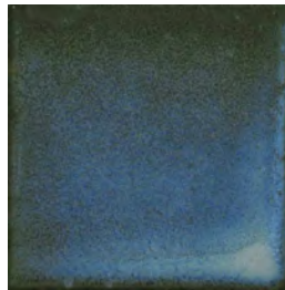
Resim 109. Mavi-Yeşil Boya Katkılı Bünyelerin Sırsız Pişme Renkleri, 1200°C
