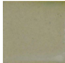
Resim 96. ZrO 2 Katkılı Bünyelerin Sırlı Pişme Renkleri, 1200°C
