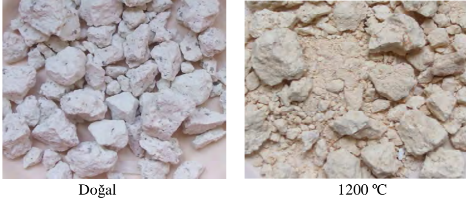
Resim 54. Dursunbey Kilinin Doğal Halde ve 1200°C'deki Pişirim Sonrası Renk Değişimi ve Ergime Davranışları
