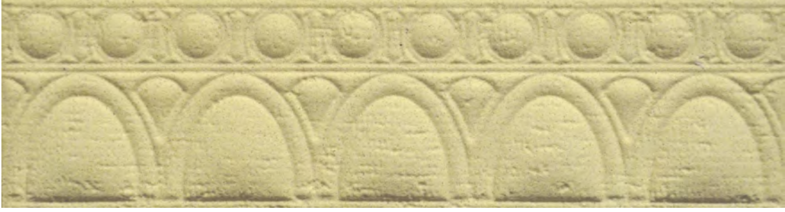
Resim 80. Dursunbey Kilinin Renklendirici Katkısı Yapılmadan Preslenmiş ve 1200°C’de Pişirilmiş Sırsız Yüzey Görüntüsü
