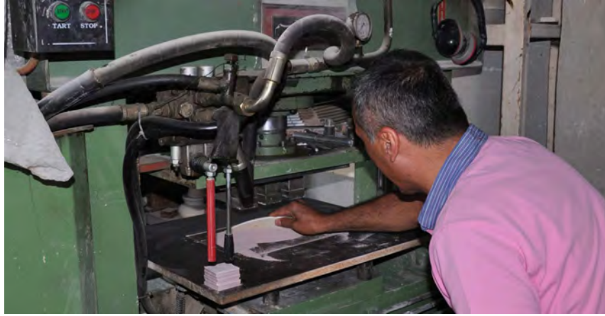
Resim 76. Kalıp Yüzeyinin Düzeltilmesi
