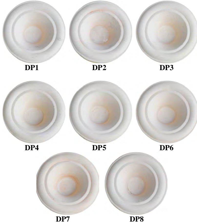
Resim 57. Dursunbey Kili, Plastik Kil Karışımlarının 1080°C'deki Sırsız Pişme Renkleri
