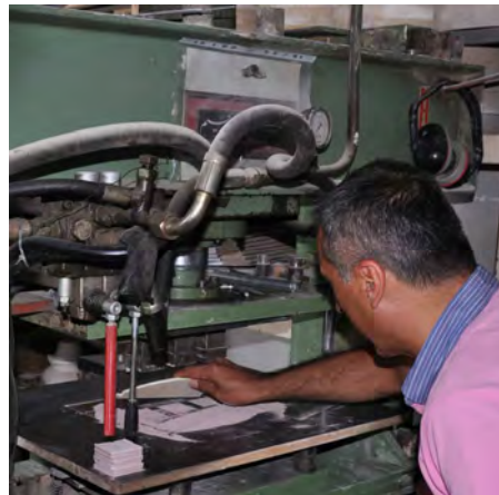
Resim 77. Kalıp Yüzeyinin Sıkıştırılması
