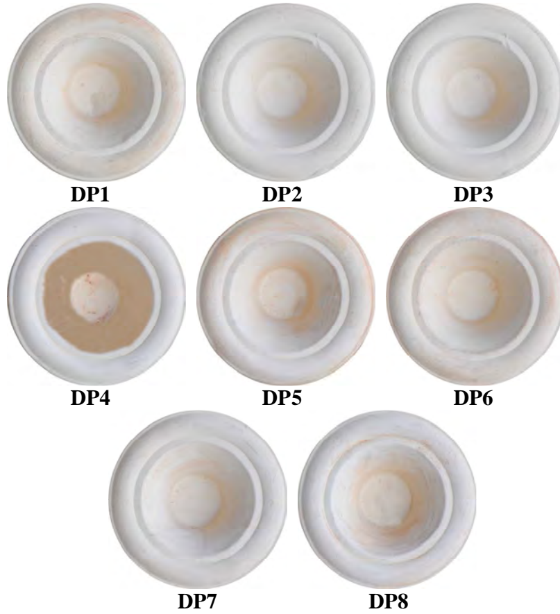
Resim 56. Dursunbey Kili, Plastik Kil Karışımlarının 1040°C'deki Sırsız Pişme Renkleri
