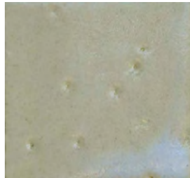
Resim 94. ZnO Katkılı Bünyelerin Sırlı Pişme Renkleri, 1200°C
