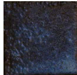
Resim 107. Siyah Boya Katkılı Bünyelerin Sırsız Pişme Renkleri, 1200°C
