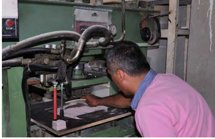
Resim 75. Pres Kalıbının Hammadde ile Doldurulması
