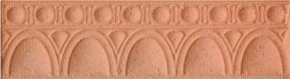
Resim 103. Turuncu Boya Katkılı Bünyelerin Sırsız Pişme Renkleri, 1200°C
