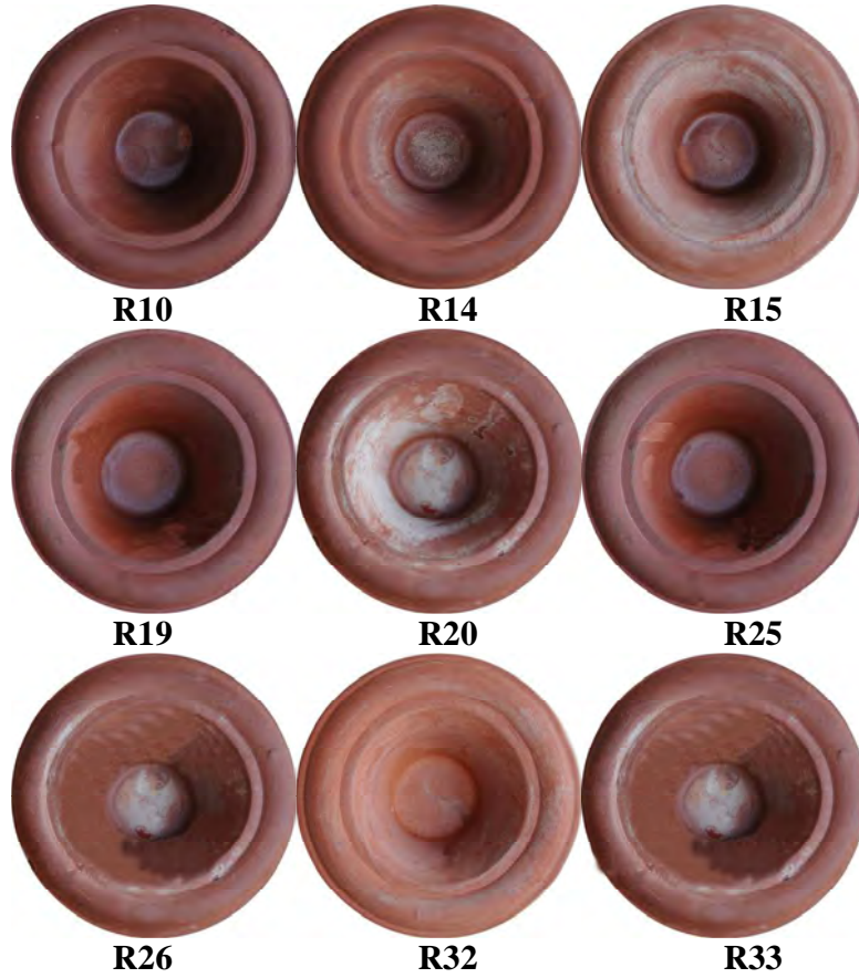
Resim 68. Üçlü Sistemde Dursunbey Kili, Atık Kırmızı Çamur ve Plastik Kil ile Oluşturulan Bünyelerin 1040°C'de Sırsız Pişme Renkleri
