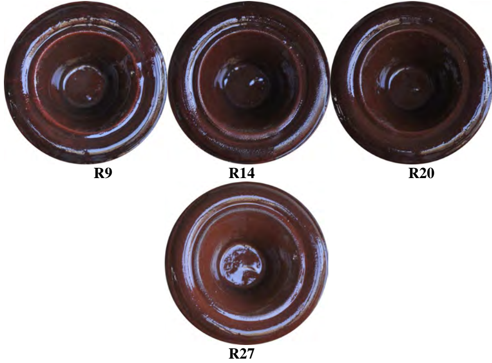
Resim 74. Atık Kırmızı Çamur, Kınık Kırmızı Kili ve Plastik Kil ile Oluşturulan Bünyelerin 1020°C'de Sırlı Pişme Renkleri
