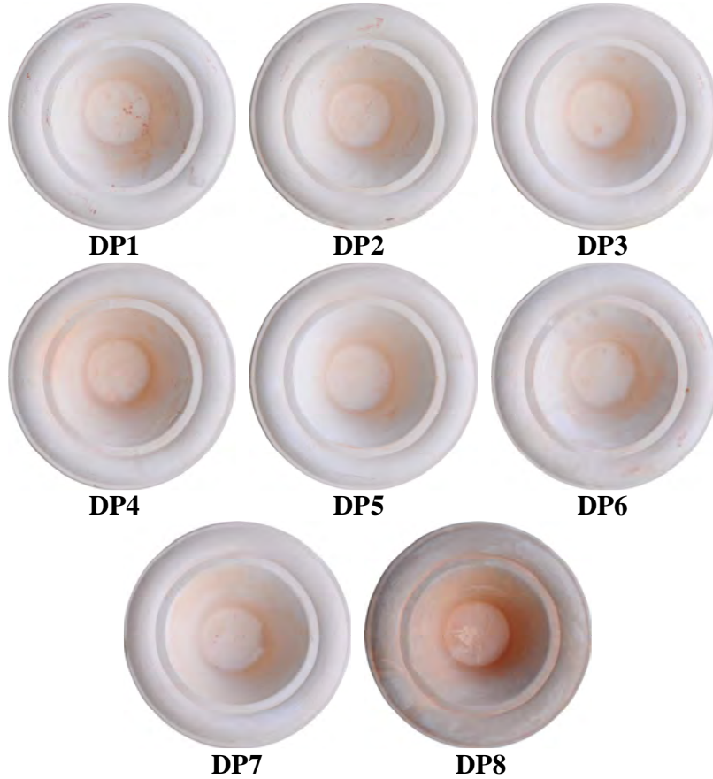
Resim 55. Dursunbey Kili, Plastik Kil Karışımlarının 1000°C'deki Sırsız Pişme Renkleri
