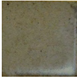
Resim 85. MnO Katkılı Bünyelerin Sırsız Pişme Renkleri, 1200°C
