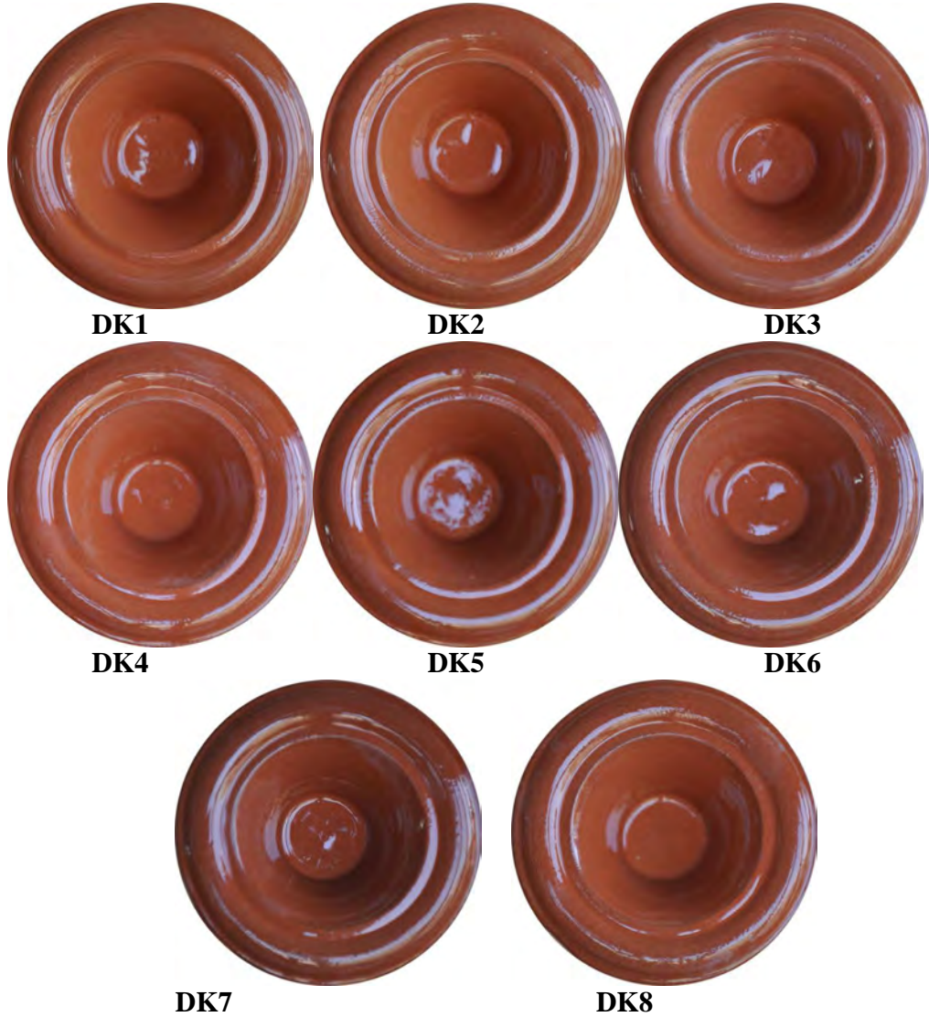
Resim 62. Dursunbey Kili, Kınık Kırmızı Kil Karışımlarının 1020°C’deki Sırlı Pişirme Renkleri
