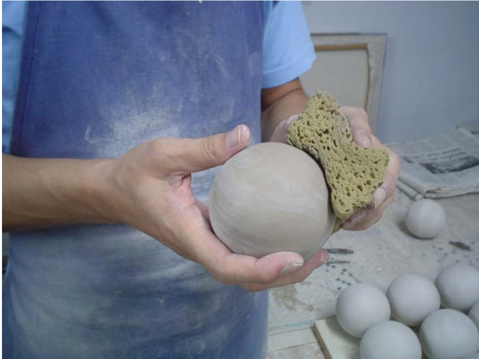
Resim 153. Dökümlerin rötuslarının yapılması.
