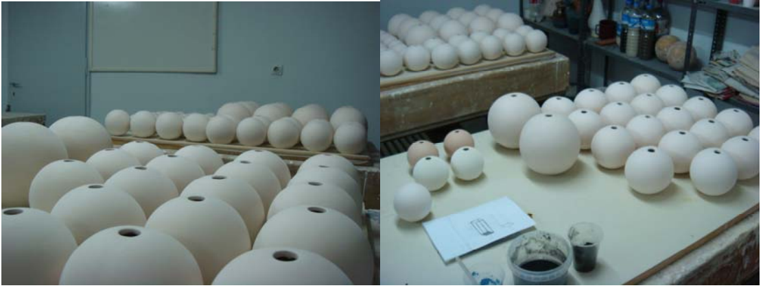
Resim 158,159. Bisküvi pişirimi yapılmış, sır ve dekorlamaya hazır ürünler.
