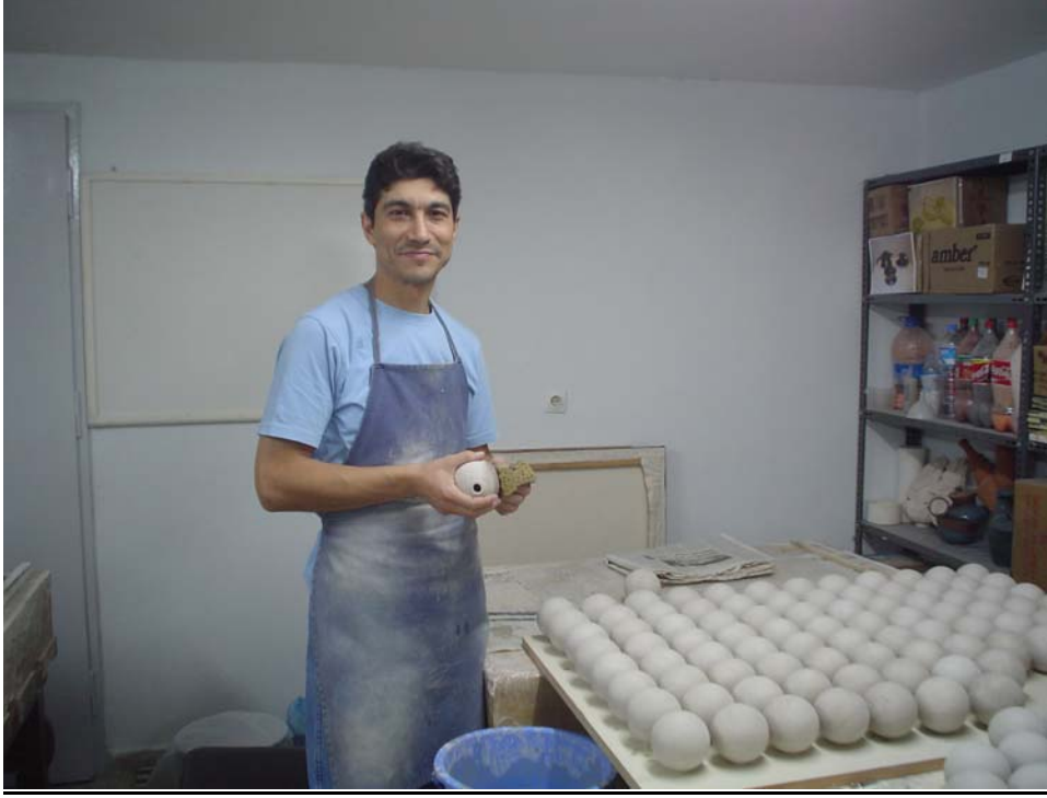
Resim 152. Dökümlerin rötuslarının yapılması.
