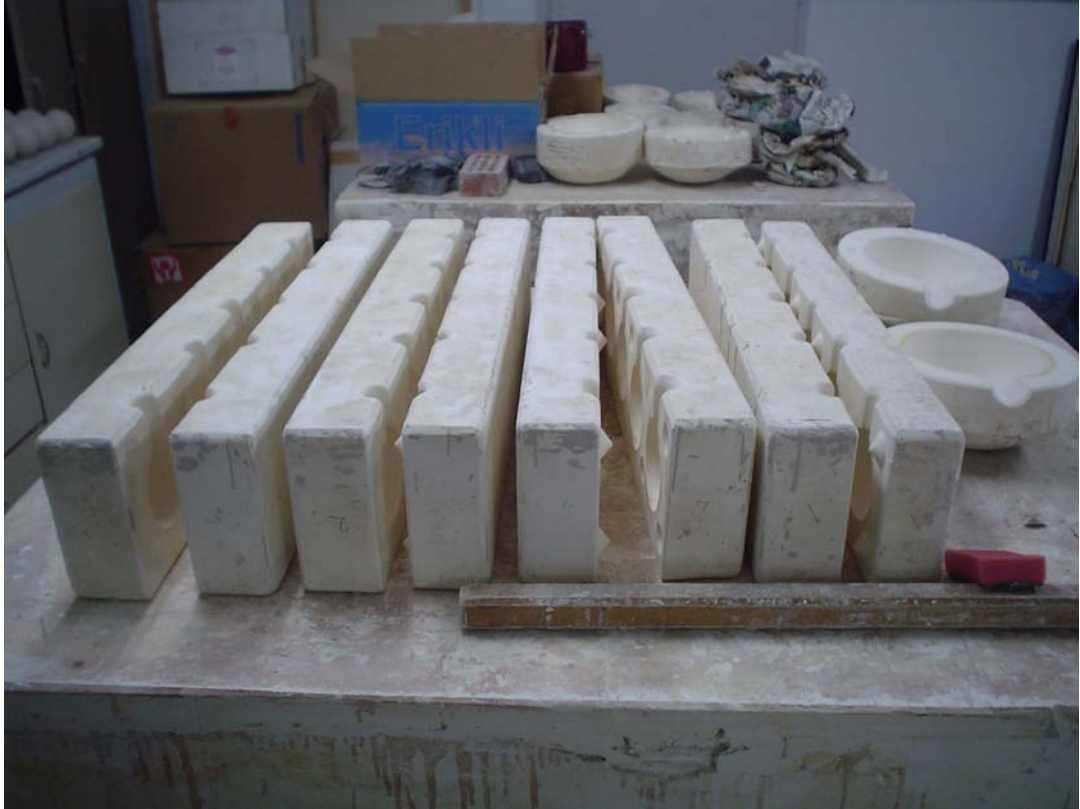
Resim 149. Birimlerin üretilmesi için hazırlanan alçı kalıplar.
