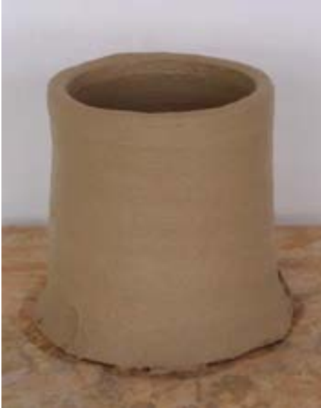
Resim 66. %4 Kağıt katkılı şamotlu bünyeye torna uygulaması.
