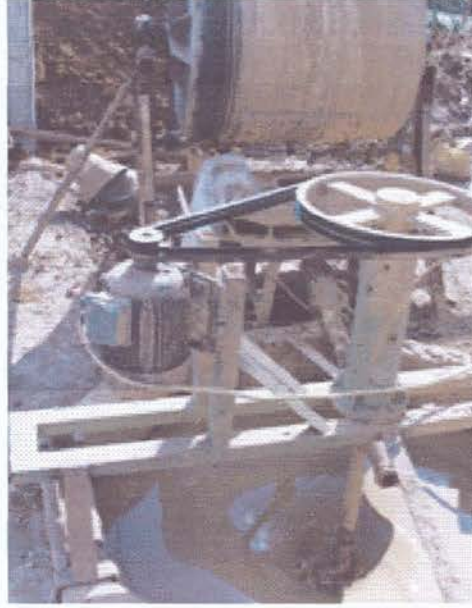
Resim 33. Çamurun hazırlanmasında kullanılan değirmen ve karıştırıcı.
