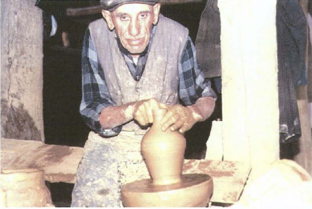
Resim 13: Tornada mlek Ađzının Yapımı
