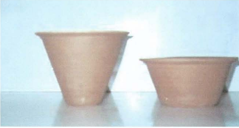
Resim 19: Şablonla Şekillendirilip, 1000 °C de Pişirilmiş Formlar
