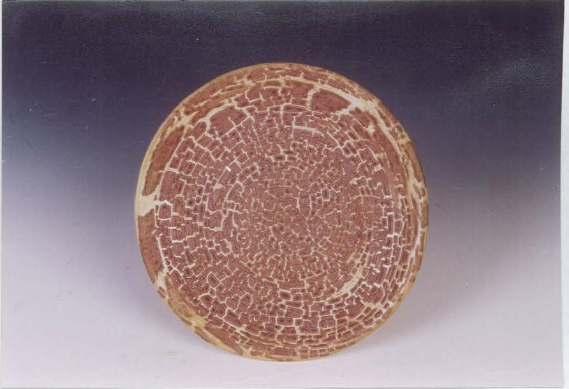
Fotoğraf – 35 Toplanmalı Sırın Yatay Yüzeyde Uygulanması
