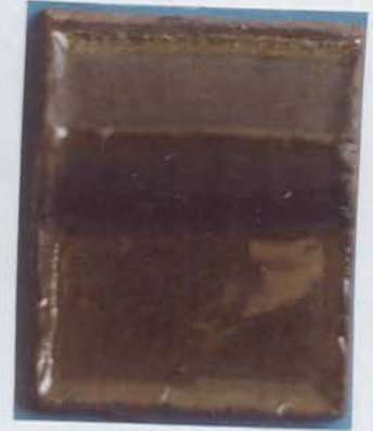
Fotoğraf 171 Reçete 2/36 %5 katkılı ( \text{Sb}_2 \text{O}_3 ) Kırmızı Çamur
