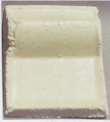
Fotoğraf 32: %5 katkılı ( Sb_2O_3 ) (1000 °C) Şamotlu Çamur
