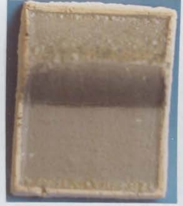
Fotoğraf 168 Reçete 1/10 %10 katkılı ( \text{Sb}_2 \text{O}_3 ) Şamotlu Çamur
