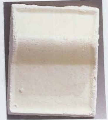
Fotoğraf 33: %10 katkılı ( Sb_2O_3 ) (1000 °C) Ş. Çamur
