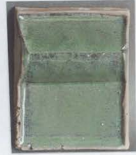
Fotoğraf 75: %10 katkılı ( \text{Cr}_2\text{O}_3 ) (1000 °C) K. Çamur
