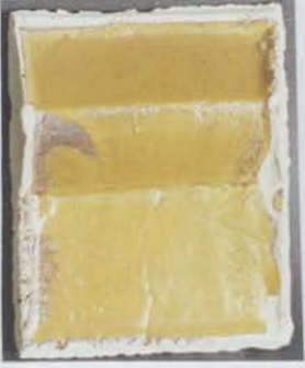
Fotoğraf 178 Reçete 1/10 %10 katkılı ( \text{Fe}_2\text{O}_3 ) Şamotlu Çamur
