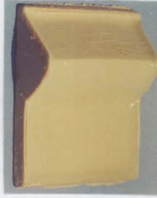
Fotoğraf 62: %5 katkı ( \text{SnO}_2 ) (1200 °C) Döküm Çamuru
