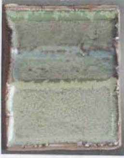
Fotoğraf 73: %3 katkılı ( \text{Cr}_2\text{O}_3 ) (1000 °C) Kırmızı Çamur
