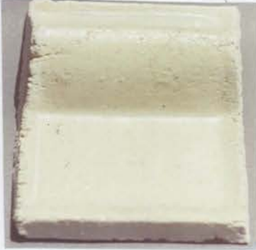
Fotoğraf 58: %3 katkıli ( \text{SnO}_2 ) (1000 °C) Şamotlu Çamur
