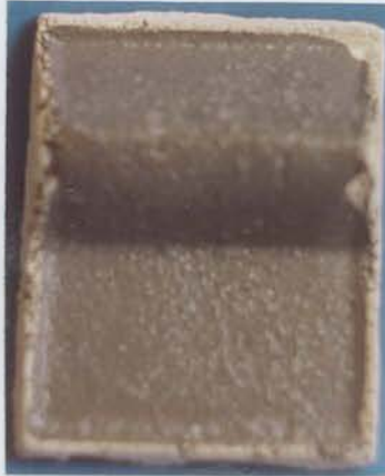
Fotoğraf 176 Reçete 1/10 %3 katkılı (SnO 2 ) Şamotlu Çamur
