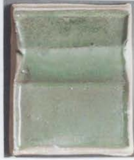
Fotoğraf 74: %5 katkılı ( \text{Cr}_2\text{O}_3 ) (1000 °C) Kırmızı Çamur
