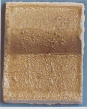
Fotoğraf 172 Reçete 1/10 %3 katkılı (Mn O 2 ) Şamotlu Çamur
