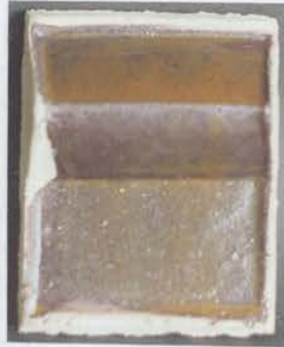
Fotoğraf 50: %5 katkılı ( Fe_2O_3 ) (1000 °C) Şamotlu Çamur
