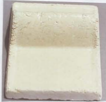
Fotoğraf 59: %5 katkıli ( \text{SnO}_2 ) (1000 °C) Şamotlu Çamur
