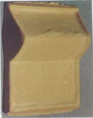
Fotoğraf 34: %3 katkılı ( Sb_2O_3 ) (1000 °C) Döküm Çamuru
