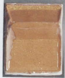
Fotoğraf 30: %10 katkılı ( Sb_2O_3 ) (1000 °C) K. Çamur
