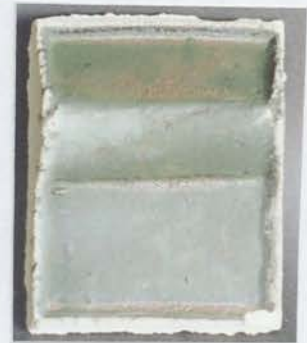
Fotoğraf 78: %10 katkılı ( \text{Cr}_2\text{O}_3 ) (1000 °C) Ş. Çamur
