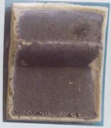
Fotoğraf 174 Reçete 1/10 %5 katkılı (CaO) Şamotlu Çamur
