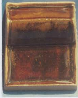
Fotoğraf 53: %5 katkı ( Fe_2O_3 ) (1200 °C) Döküm Çamuru
