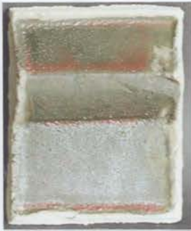
Fotoğraf 76: %3 katkılı ( \text{Cr}_2\text{O}_3 ) (1000 °C) Şamotlu Çamur
