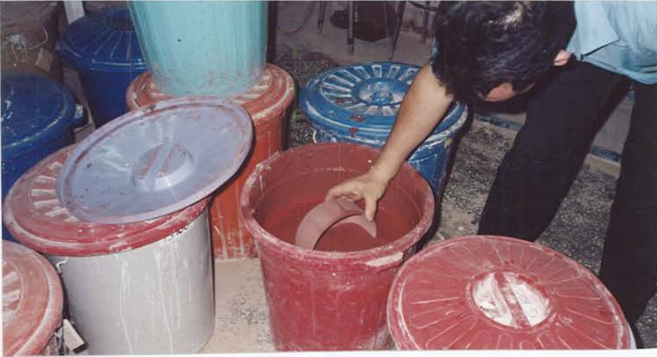
Resim 12: Daldırma Tekniđi İle Sırlama
