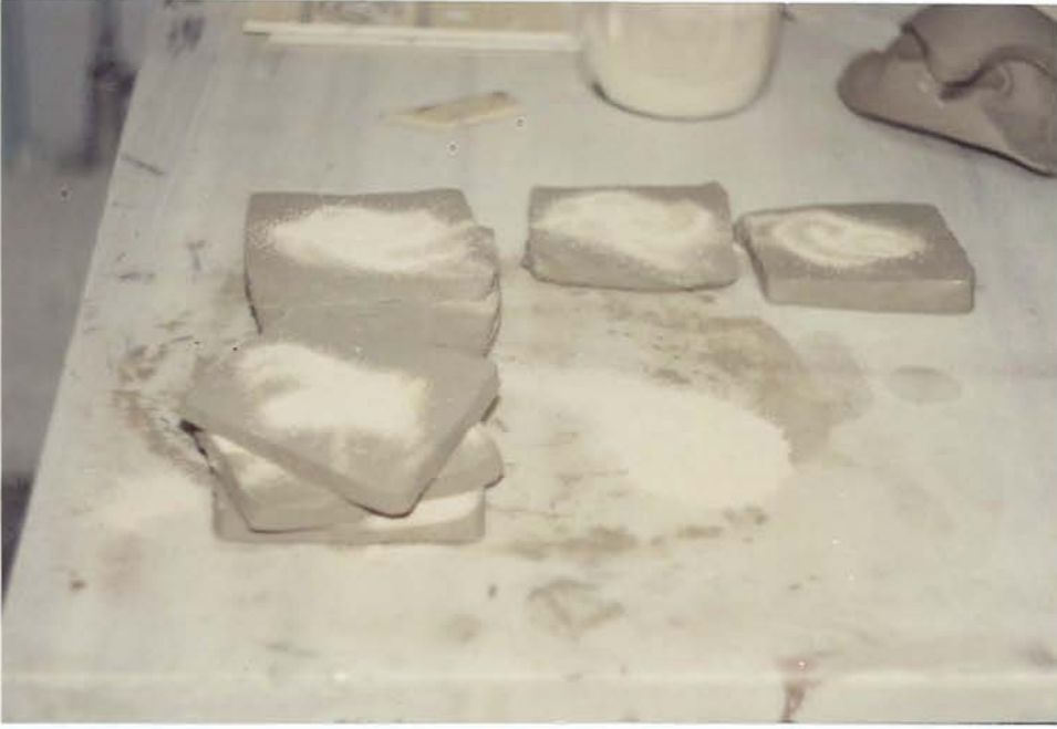
Resim 2: Çamura Toz Haldeki Hammaddelerin Katılması
