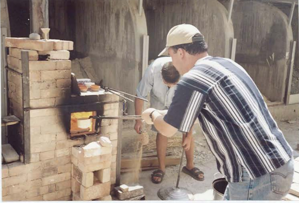
Resim 29: Raku Fırınına Kap Konulması
