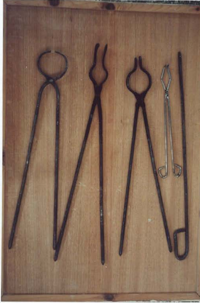
Resim 17: Raku Pişiriminde Kullanılan Maşalar
