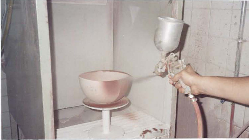
Resim 13: Püskürtme Tekniği İle Sırlama
