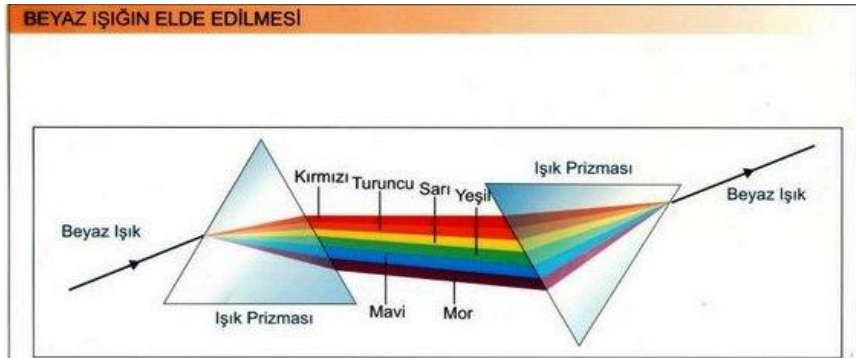
Görsel 6. Newton'un deneyi, beyaz ışığın kırılması
