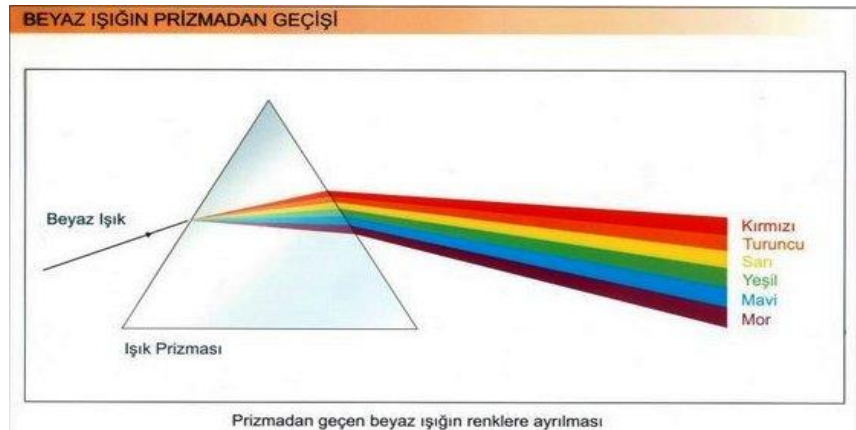
Görsel 7. Newton'un deneyi, beyaz ışığın renklere ayrılması
