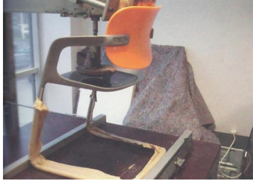
Resim 48 Soul Chair için gerçek malzemesi ve üretim tekniği kullanılarak üretilen ve kullanım testleri uygulanan beta prototip
