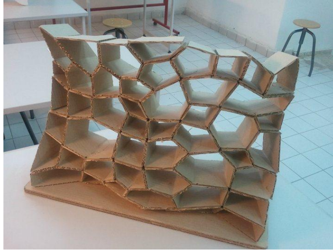
Resim 74 Voronoi Hafif Mekan Bölücü için 1/5 ölçekli deneme maketi
