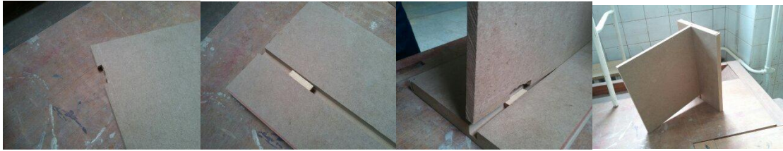
Resim 93 Sökülür-takılır hale dönüştürmek üzere kamalarla geçme denemeleri
