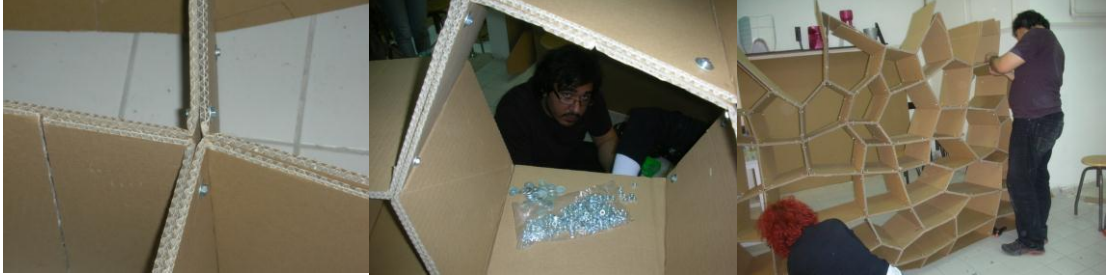
Resim 79 Voronoi hafif mekan bölücünün parçalarının vida ve somunlarla bir araya getirilmesi
