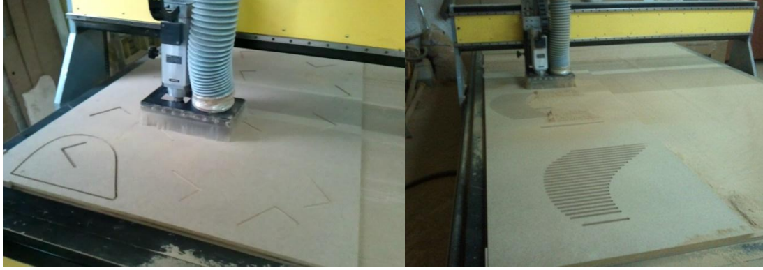
Resim 88 CNC freze ile dilimlerin ve tabanın işlenişi
