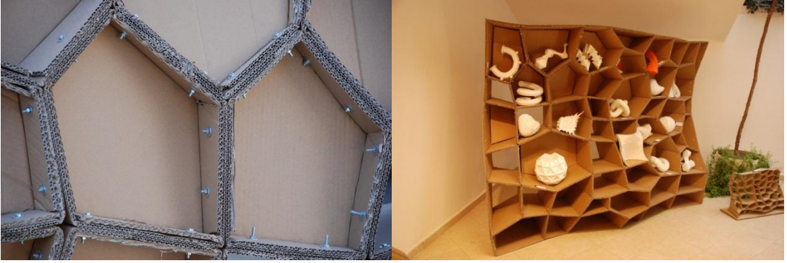
Resim 81 Voronoi hafif mekan bölücü elemanın taşıyıcı hale getiren destek kapakları ve bitmiş hali
