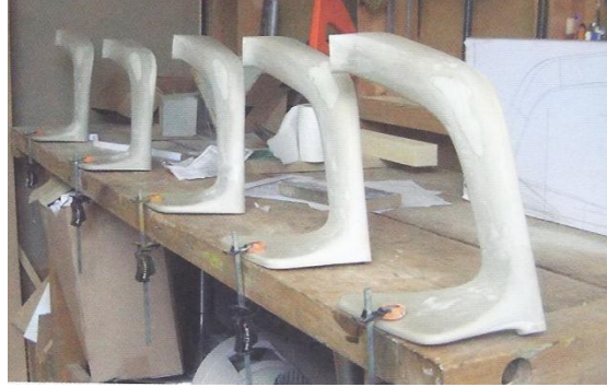
Resim 45 Soul Chair için köpük malzeme ile üretilen deneysel kolçak prototipleri
