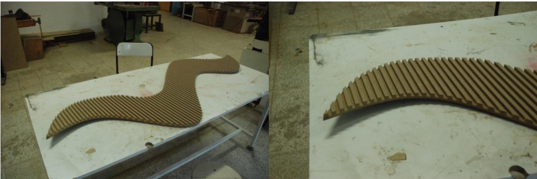
Resim 92 Frezede eksiltildikten sonra bükülen taban
