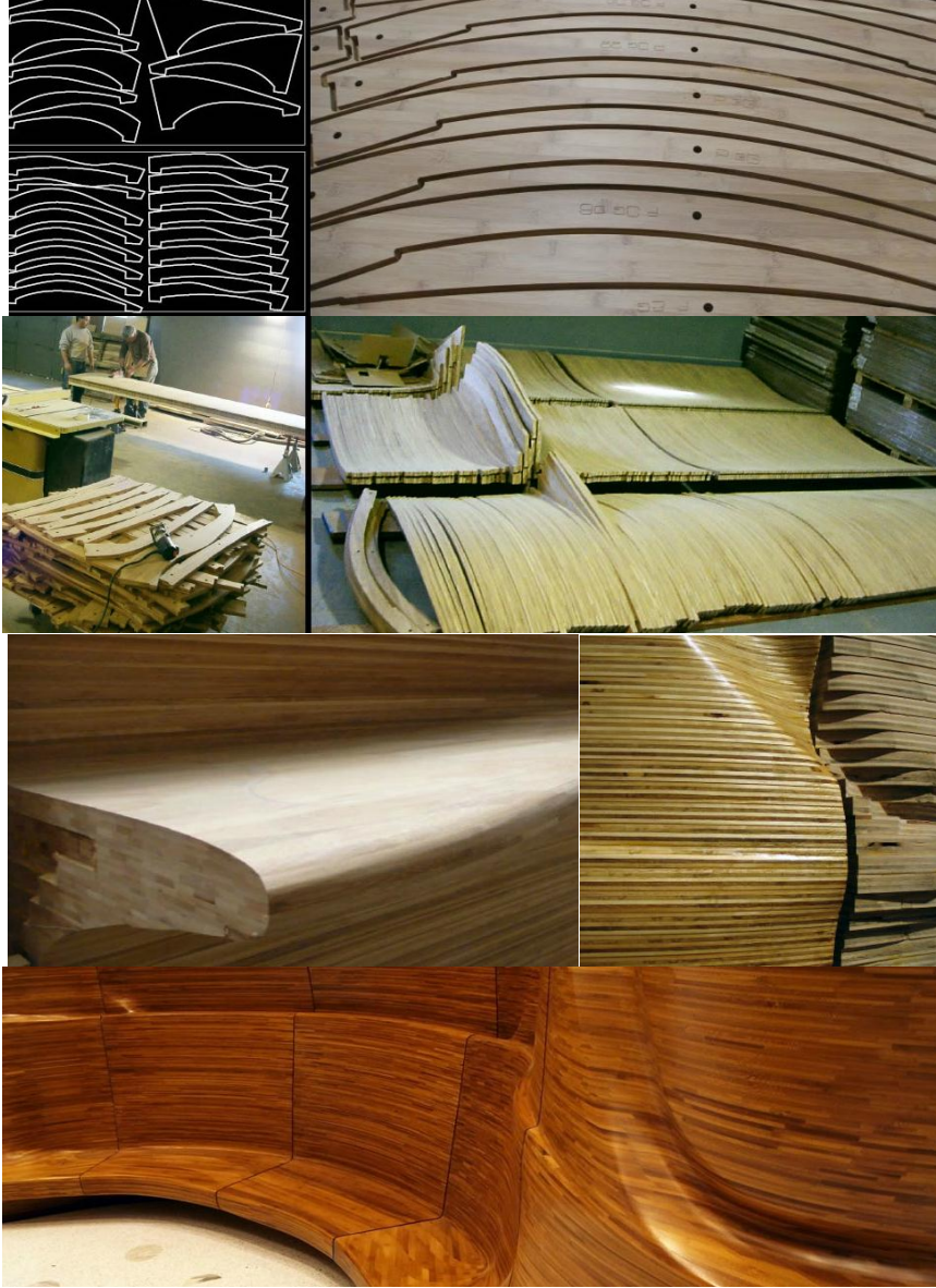
Resim 17 KPF architects tarafından tasarlanan ve SITU Studio tarafından uygulanan lobi mobilyaları üretiminde kesit alma laminasyon tekniği ile kullanılmıştır.
