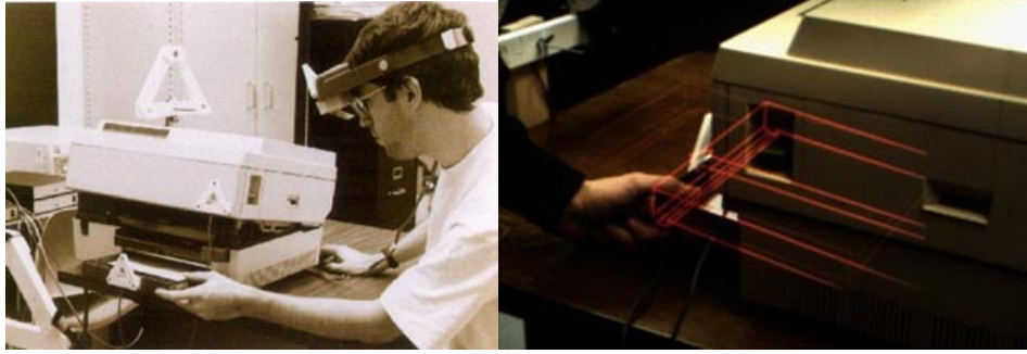
Resim 5 Katkılandırılmış gerçeklik kullanılarak fotokopi makinelerinin tamiri
