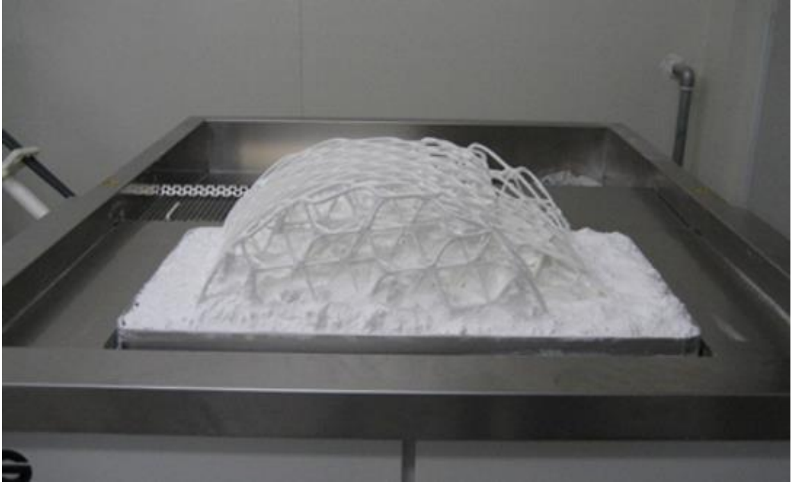
Görsel 18. SLS baskı sonrasında çıktının tozlardan arındırılması
