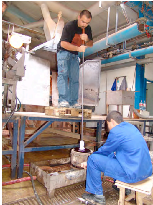
Resim 22: Üfleme Tekniği, Üfleme Çubuğundaki Cam Kütle Kalıba Üfleme
