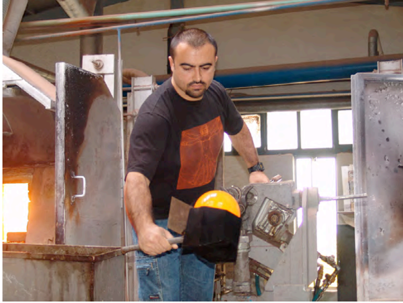
Resim 21: Üfleme Tekniği, Üfleme Çubuğu Üzerindeki Cam Kütle Biçimlendirme Aşaması
