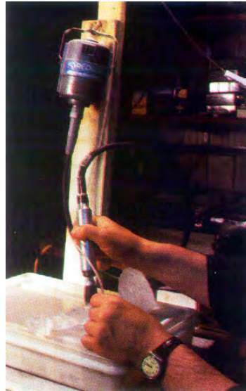
Resim 26: Taşla Aşındırma Oyma Tekniđi, Elektrikli El Frezesi
