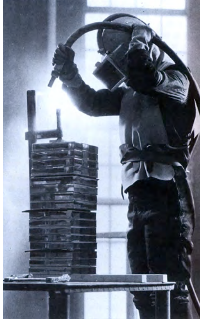
Resim 28: Kumla Aşındırma Tekniği, Kum Püskürtme Düzeneği
