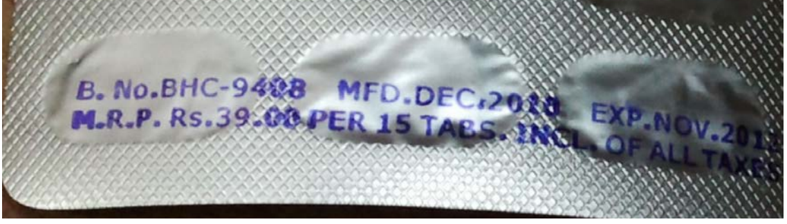
Görsel 71. Kullanıldığı anda folyonun yırtılması ile son kullanma tarihinin okunması güçleşecek ya da imkansız hale gelecek olan hatalı bir ilaç ambalajı.
