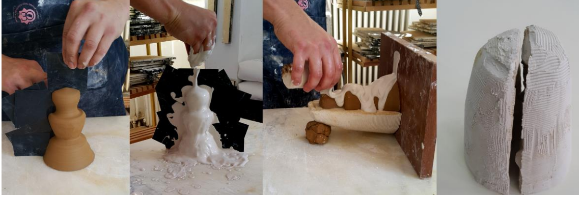
Görsel 8. Yumuşak plastik plakaların yerleştirilmesi, 1. ve 2. parça için model yüzeyinin refrakter kalıp karışımı ile kaplanması ve model çıkarılmış kalıp parçaları
