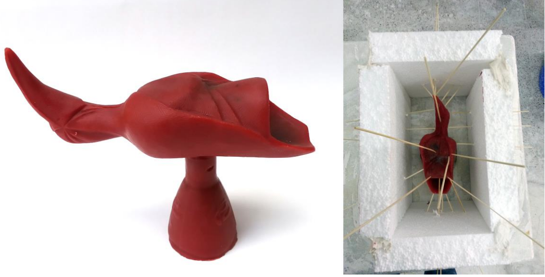
Görsel 16. İlker Yaman'a ait silikon kalıpla şekillendirilmiş mum model, hava tahliye kanalları oluşturulması
