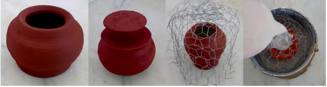
Görsel 10. Mum model, döküm ağız parçasının modele eklenmesi, model çevresine kümes telinden kafes oluşturulması ve modelin refrakter kalıp karışımıyla kaplanması
