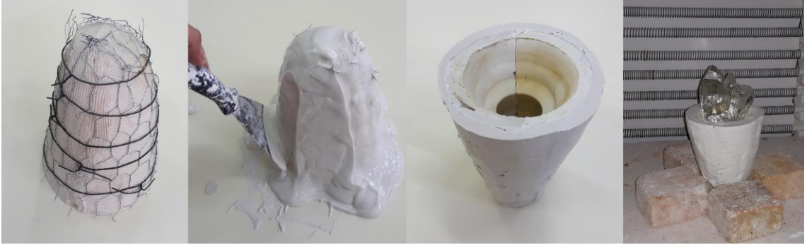
Görsel 9. Kalıp parçalarının birleştirilerek tel ile sarılması ve sıkıştırılması, kalıp parçalarının forma uygun şekilde refrakter kalıp karışımı ile sıvanması ve çift parçalı kalıptan oluşturulan kalıbın tek parça haline getirilerek fırına yerleştirilmesi
