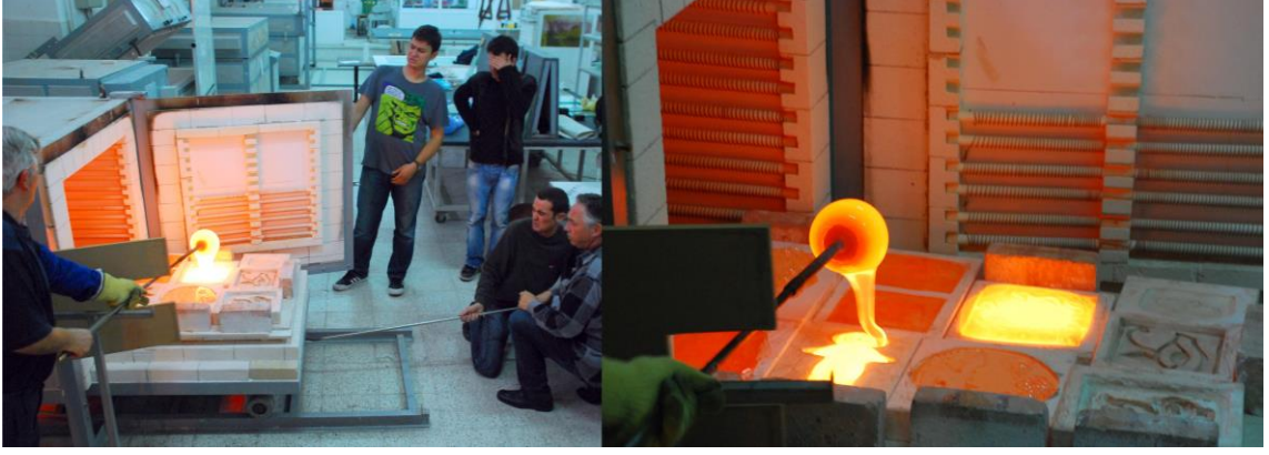
Görsel 25. Fırında Sıcak Cam Döküm Süreci
