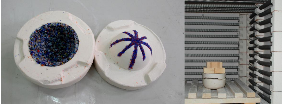
Görsel 19. Cam paketlemesi yapılmış iç ve dış kalıp parçası ve fırına yerleştirilmesi
