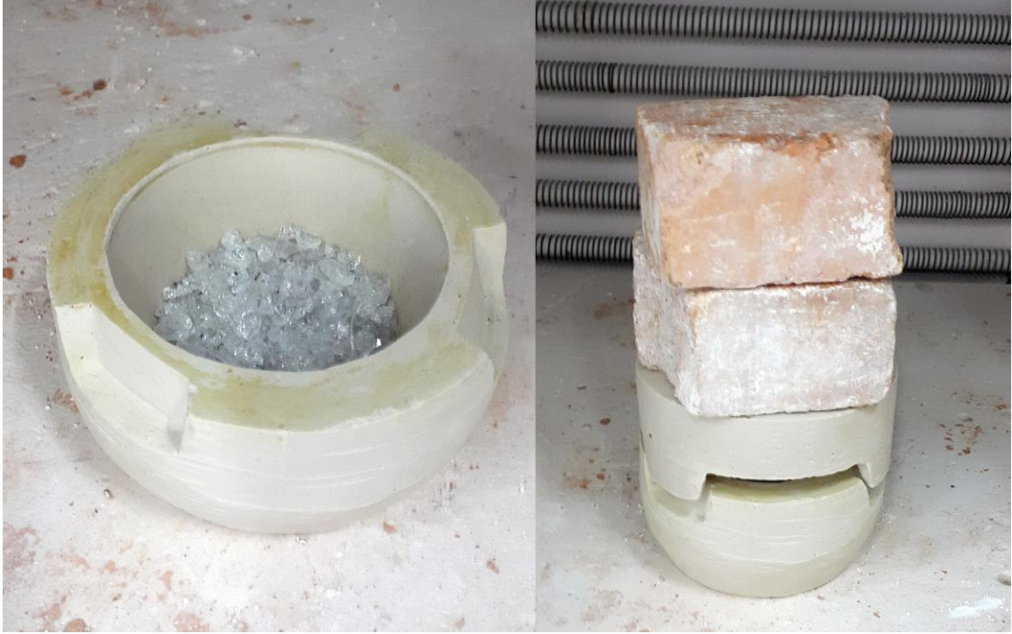
Görsel 14. Cam yüklemesi yapılmış ve üst parçası yerleştirilmiş hareketli maçalı kalıp
