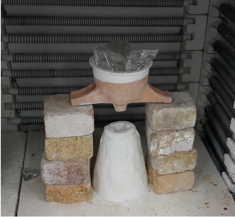
Görsel 20. Cam yüklemesi yapılmış pota (Pota şamotlu çamurdan üretilmiştir)
