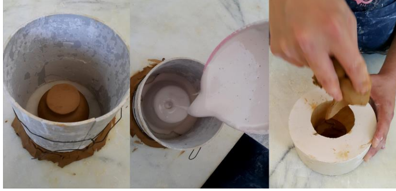
Görsel 7. Açık kalıp modelinin zemine yerleştirilerek kalıp kurgusunun hazırlanması, refrakter kalıp karışımının model üzerine dökülmesi ve modelin kalıptan çıkarılma süreci.
