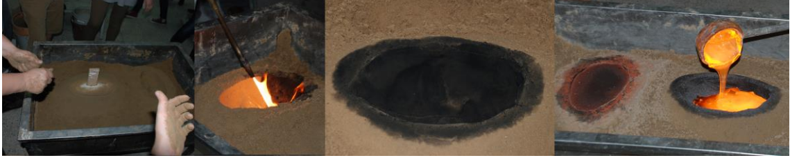
Görsel 27. Modelin kum yatağına bastırılarak, kenarlarının sıkılaştırılması, kum kalıbın karbonlanması ve sıcak cam dökümü
