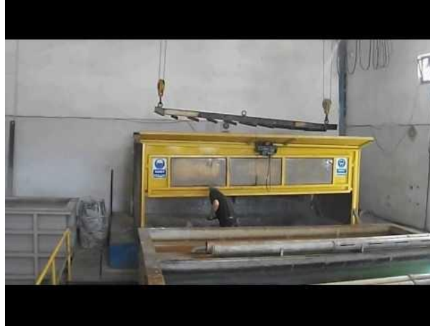
Görsel 11. Sıcak Daldırma Galvaniz Kaplama Yöntemi
