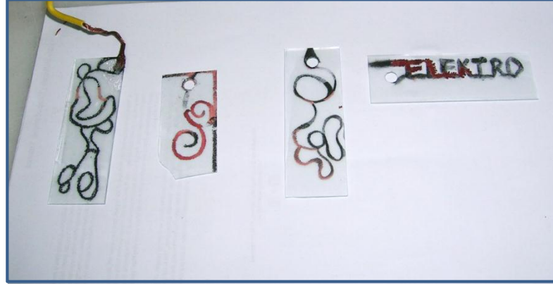
Görsel 39. Kumlanmış Plaka Cam Üzerinde Kalem İle Çizilen Motiflerin Bakır Elektrokaplama Uygulanması
