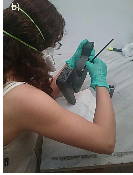
Görsel 73. a) Soğuk İşlemden Sonra Yüzeyin Pürüzlendirilmesi b) Pürüzlendirme İşleminin Ardından Grafit Sürülmesi.
