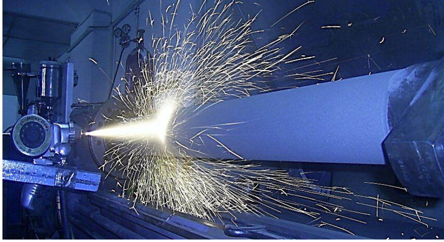
Görsel 12. Sıcak Tel Püskürtme Uygulaması
