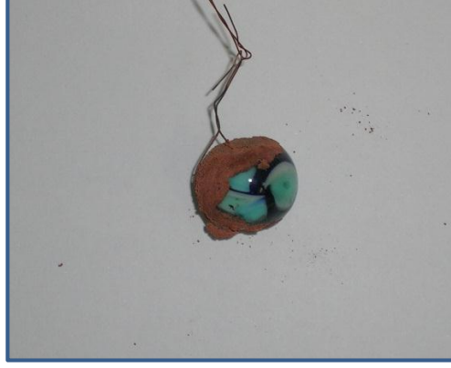
Görsel 40. Ticari İletken Karbonlu Boya İle Metalize Edilip ve 0,1 A ile 90 Dakika Kaplanması Sonrası Görsele.
