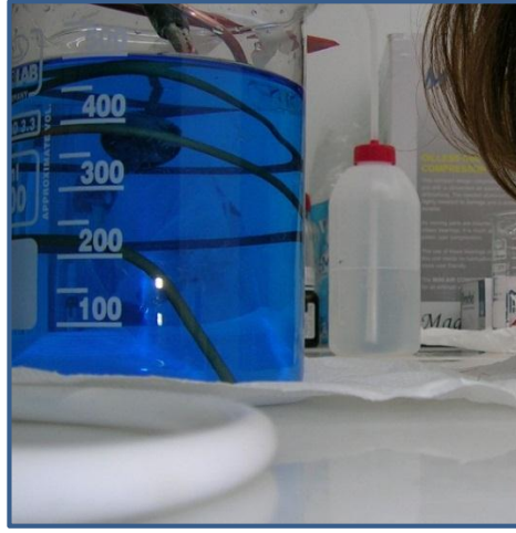
Görsel 41. Asit Esaslı Solüsyon İçerisinde Liquid İletken Boya İle Metalize Edilmiş Yüzeyin Kaplanması (elektrokaplama).
