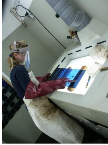
Görsel 23. Cam Yüzeyini HF Asit İle Aşındırma
