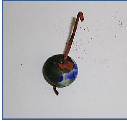
Görsel 42. Ticari Sıvı İletken Boya İle Kaplanmış ve 0,1 A Uygulanarak 260 Dakika Boyunca Kaplanmıştır.
