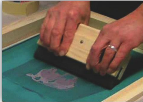
Görsel 76: Ragle ile boyanın çekilmesi
