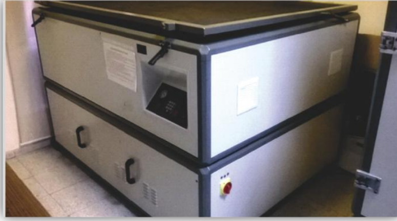
Görsel 23: Serigrafi atölyesi pozlama makinesi
