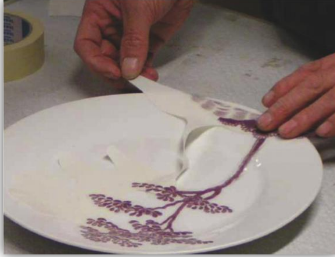
Görsel 81: Dekal kağıdının seramik tabak üzerine yerleştirilmesi
