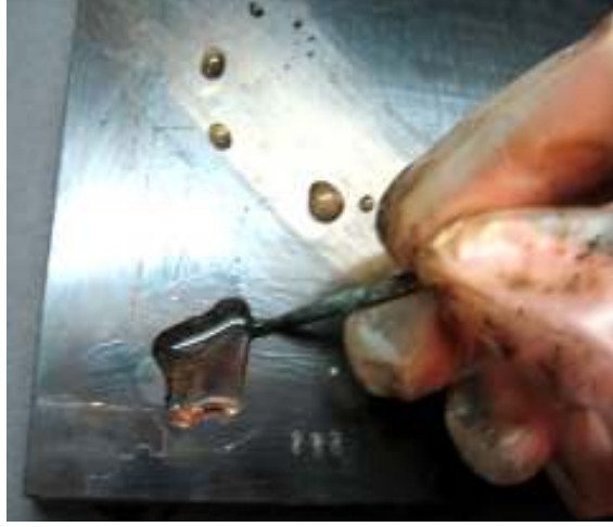
Resim 9: Asfalt Kaplı Kalıba Fırçayla Asit Uygulama
