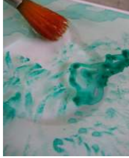
Resim 32: Kalıba Fırçayla Silikon Uygulaması
