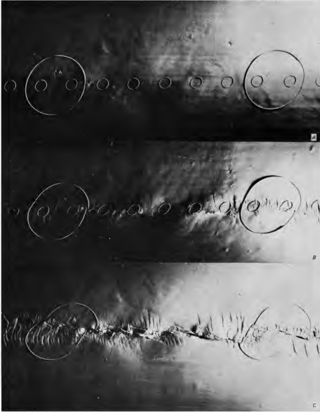
Şekil 4.11. Wilcox ve ark. (1973) tarafından yapılmış sağ yönlü faylarda görülen kırık sistemleri (Görüntülerdeki A,B ve C gelişimin ilerleyişini göstermektedir)
