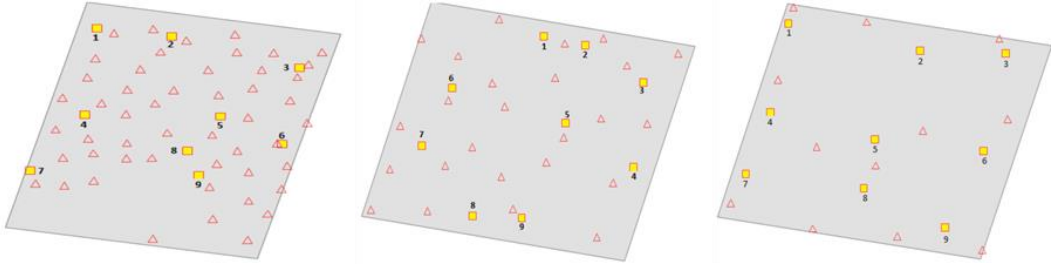
Şekil 4.7. İstanbul 50 YKN (Sol), Ankara 25 YKN (Orta), Osmancık 12 YKN (Sağ) görüntüleri için YKN ve BDN dağılımı. (BDN'ler sarı ile işaretlenmiştir)
