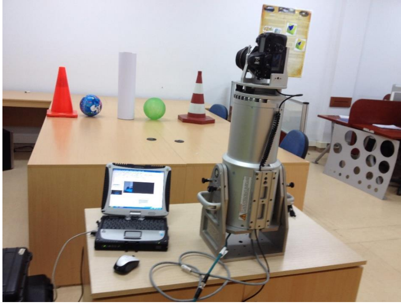
Şekil 5.1. Laboratuvar ortamında hazırlanan tarama düzeneği
