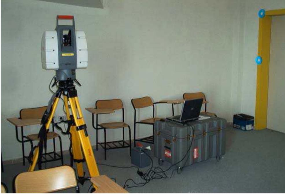
Şekil 3.7. Yersel lazer tarayıcıların sistem bileşenleri (Ergün, 2011)
