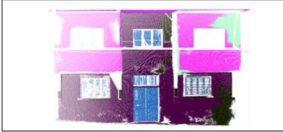
Şekil 5.26. t = 2 cm değeri için veri setinden çıkarılan ilk altı düzlem
