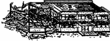
Şekil 3.21. Betonarme tipli bir binada çok ağır hasar seviyesindeki durum ve göçme ( http://www.ibb.gov.tr/deprem/mikrobolgeleme/afetonlem-kisim8.pdf ).
