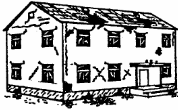
Şekil 3.16. Yığma tipli bir binada ağır hasar seviyesindeki durum
