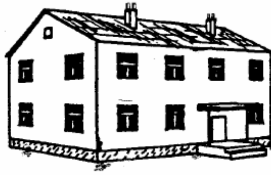
Şekil 3.14. Yığma tipli bir binada az hasar seviyesindeki durum
