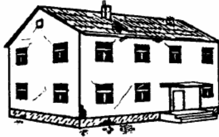
Şekil 3.15. Yığma tipli bir binada orta hasar seviyesindeki durum
