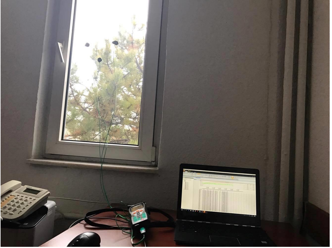
Görsel 5.10. Terminal binası pencereleri U değeri ölçümü
