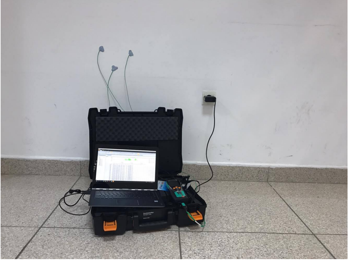
Görsel 5.9. Terminal binası dış duvarları U değeri ölçümü
