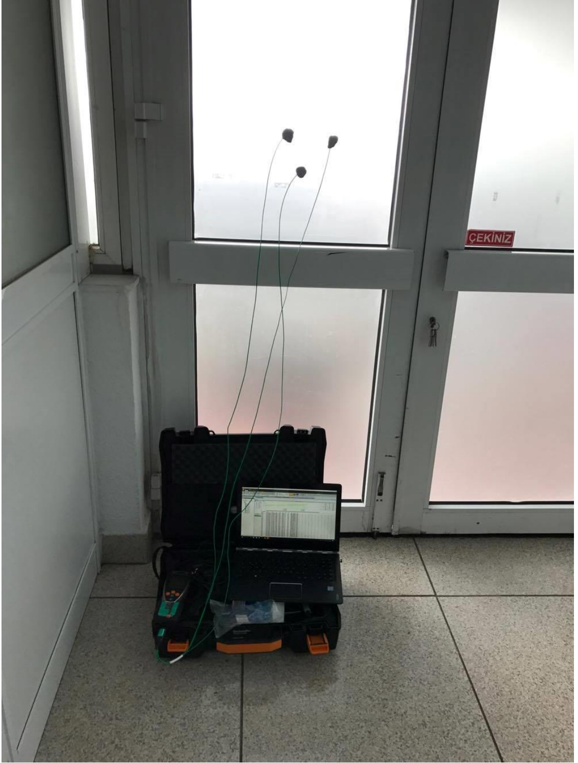
Görsel 5.11. Terminal binası dış kapıları U değeri ölçümü
