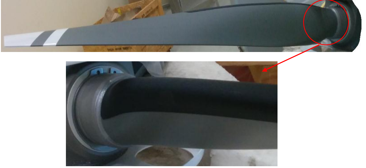
Şekil 2.5. 2 metre çapındaki pervane pali ve kök (shank) formu
