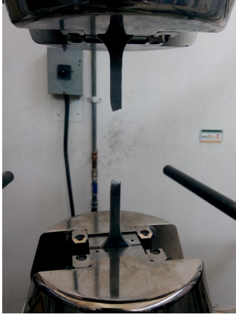
Şekil 4.7. Kırılarak kopan yorulma testi numunesi
