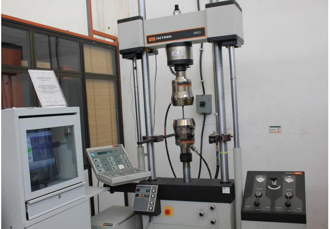
Şekil 4.2. Çekme ve yorulma testlerinin yapıldığı Instron test cihazı
