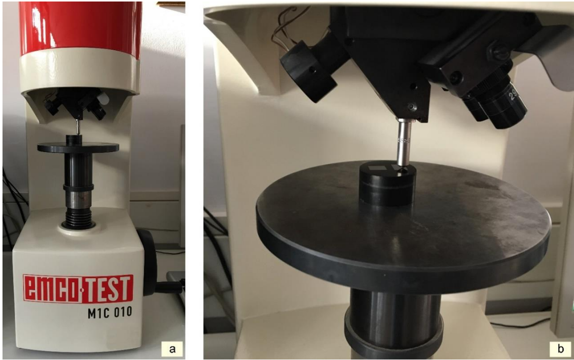
Şekil 4.1. a) Sertlik testlerinin yapıldığı sertlik ölçüm cihazı b) Sertlik testlerinin uygulandığı numuneler
