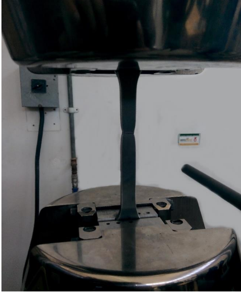
Şekil 4.5. Çekme testi sonucu kopan numune
