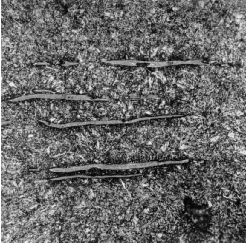
Şekil 3.10. Yüksek mukavemetli bir çelik içerisinde bulunan cüruf kalıntısı
