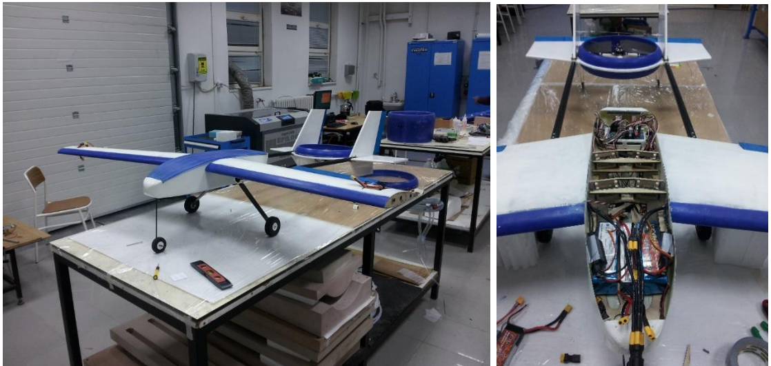
Şekil 7.8. İlk montajı yapılmış ana uçak ve iç yerleşimi
