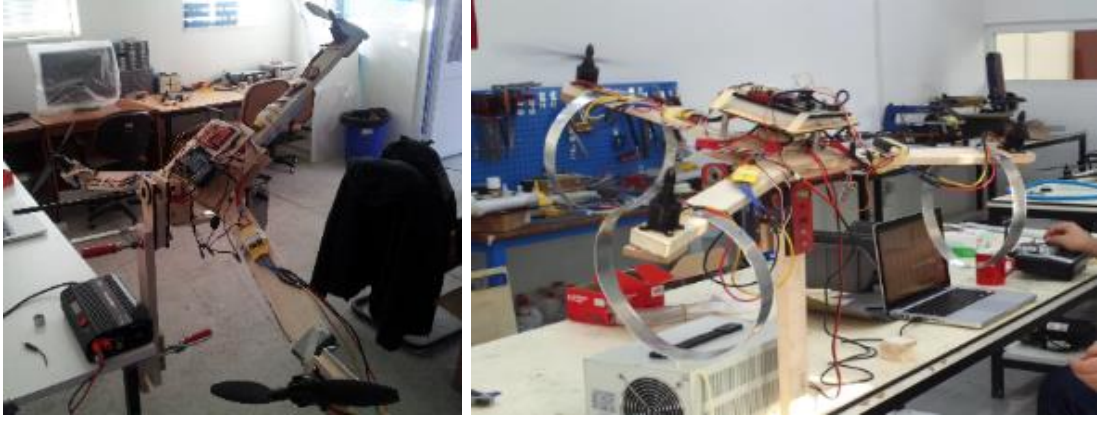
Şekil 7.1. Kontrol donanımı testleri için imal edilen a) V1 ve b) V2 test platformları
