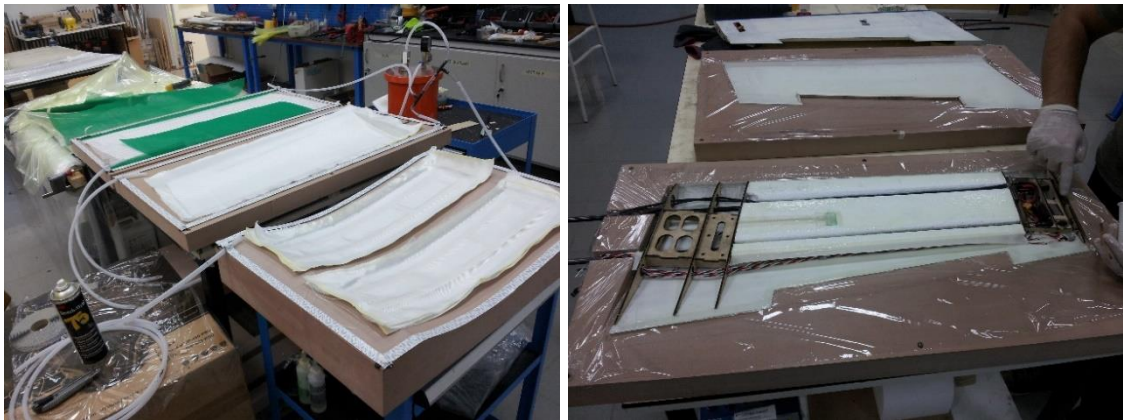
Şekil 7.6. Kompozit imalatı ve kanat iç kısım montajı
