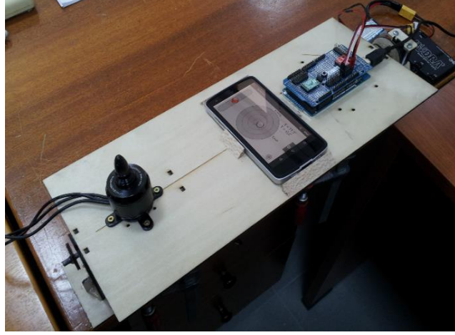
Şekil 6.4. Açık ölçüm testleri için imal edilen tek eksen test düzeneği
