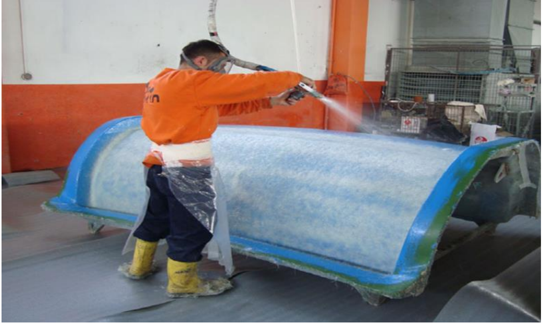
Şekil 3.2 Püskürtme işlemi uygulaması
