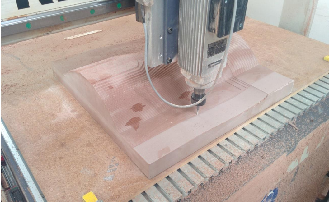
Şekil 5.8. İç parça kalıp son işlemi
