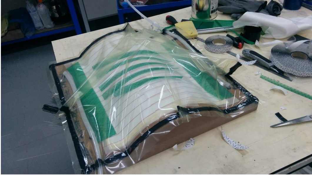
Şekil 5.18. Vakum naylonunun kaplanması
