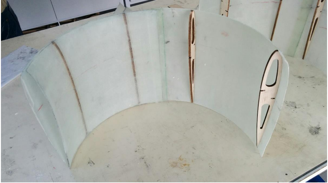
Şekil 5.28. İç kabuk parçalarının yapıştırılması
