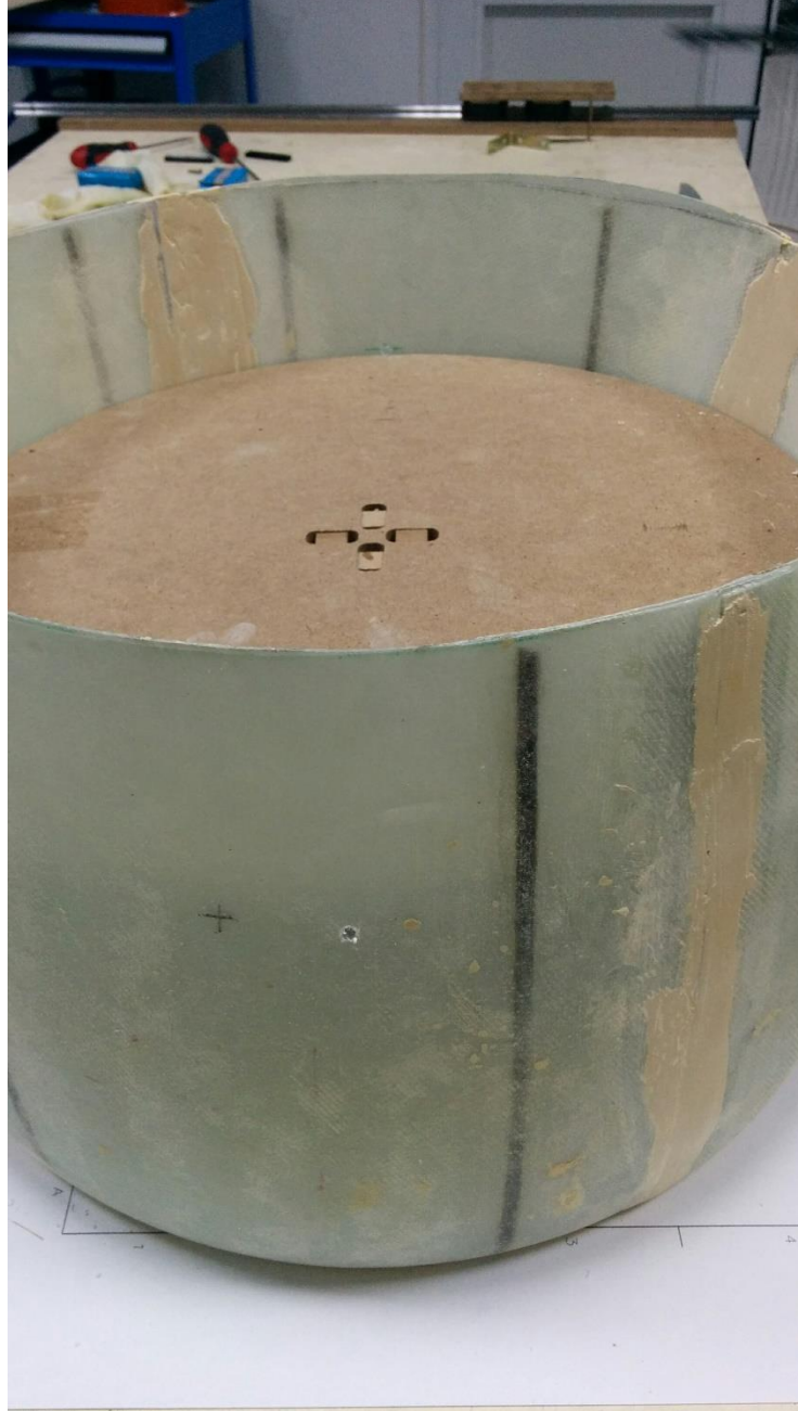
Şekil 5.31.Motor bağlantı noktalarının açılması
