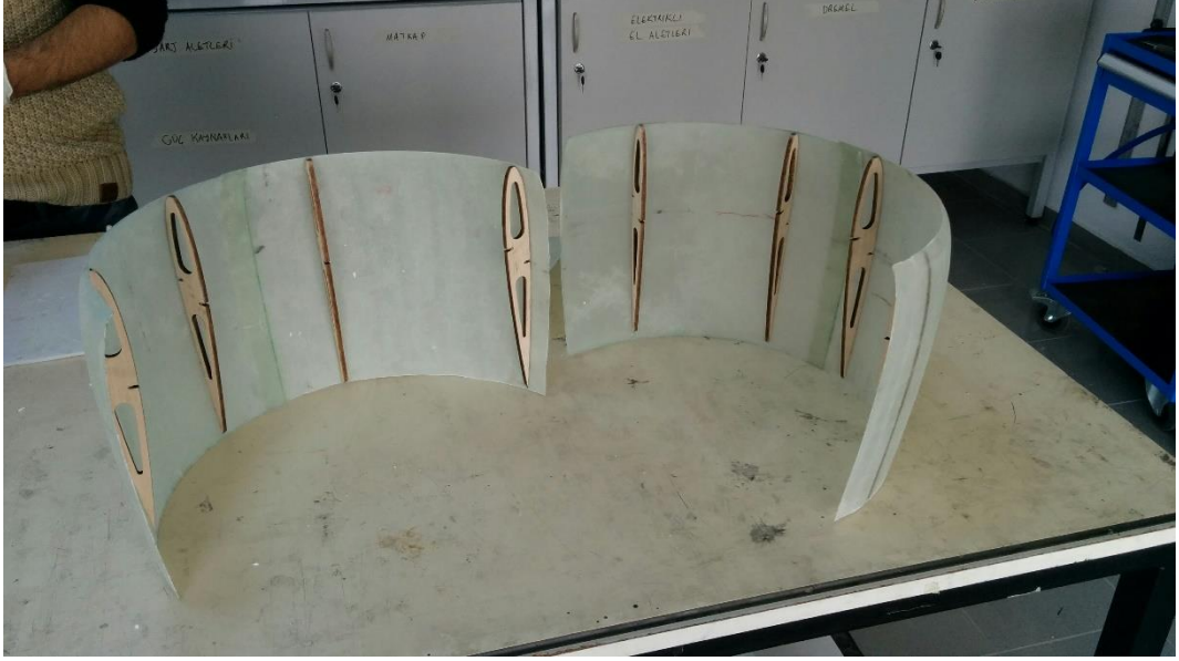
Şekil 5.27. Dış kabukların birbirine yapıştırılması
