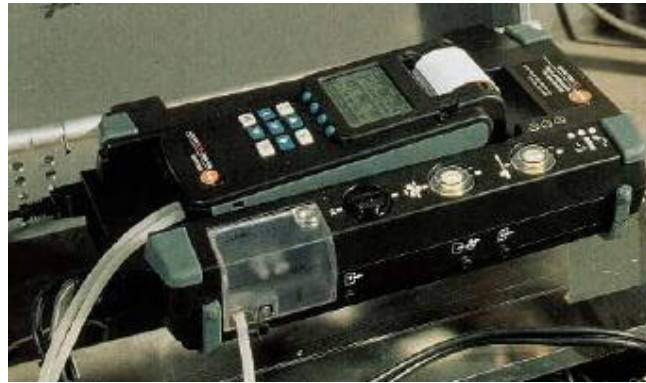
Şekil 5.10. TESTO 350XL gaz analizörü
