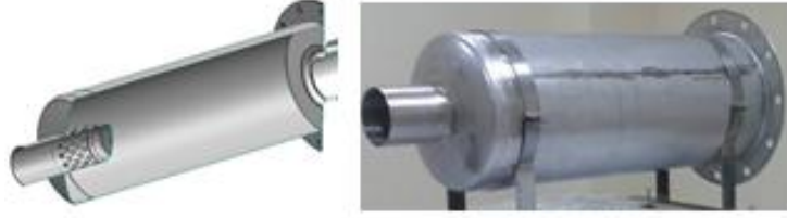
Şekil 4.4. Akış düzeltici tasarım ve imalatı
