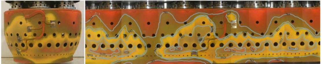
Şekil 5.8. Dış gömlek panoramik görüntüsü ve sıcaklık geçişleri
