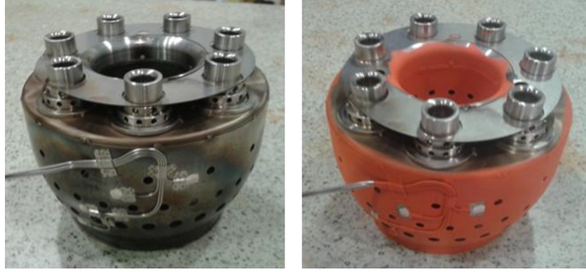
Şekil 5.6. Enstrümante edilmiş yanma odası
