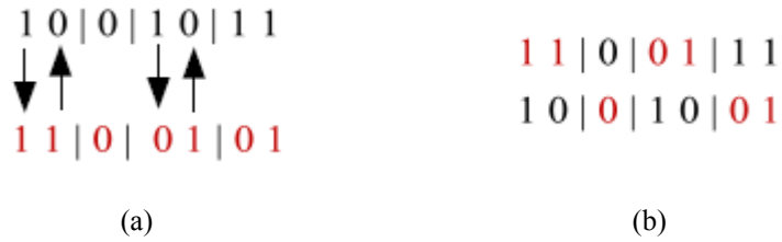
Şekil 5.8. Çok kesimli çaprazlama (a) çaprazlama öncesi, (b) çaprazlama sonrası bireyler [27]
