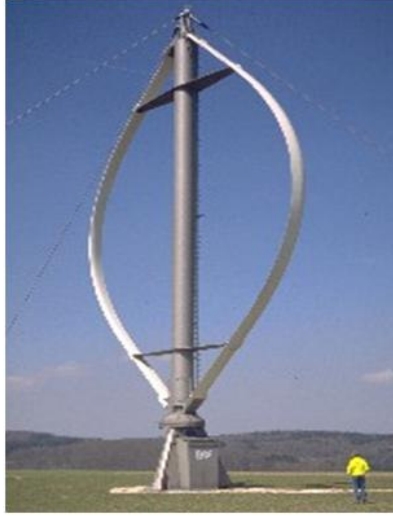
Şekil 3.10. Düşey eksenli bir rüzgâr türbini örneği [35]
