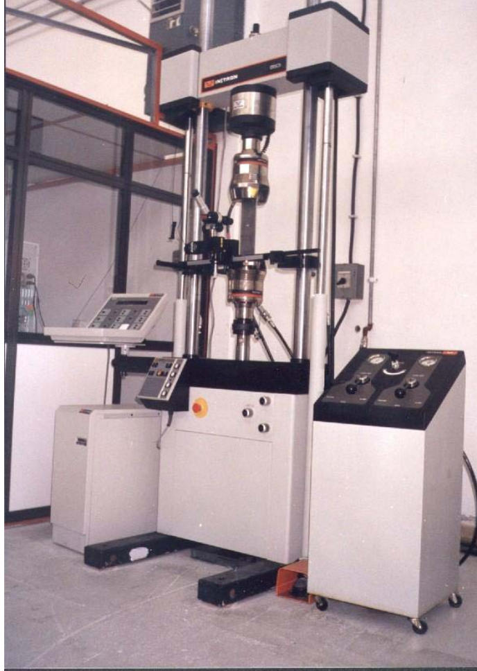
Şekil 3.3. Yorulma deneylerinde kullanılan Instron cihazı
