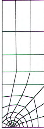
Şekil 7.15. Çatlaklı bir levhanın yarım simetrik modeli [3]
