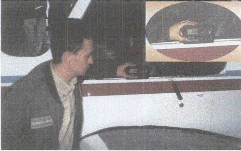
Şekil 6.13. Uçağın uzunlamasına eksen yatay durum ayarı
