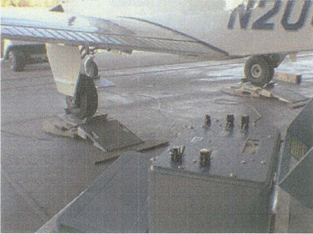
Şekil 4.4. Rampa tip elektronik ağırlık ölçme cihazı
