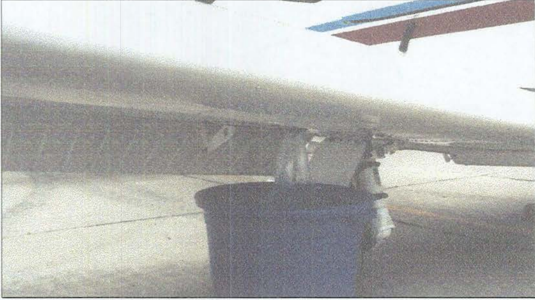
Şekil 4.8. Uçak depolarından yakıtın boşaltılması
