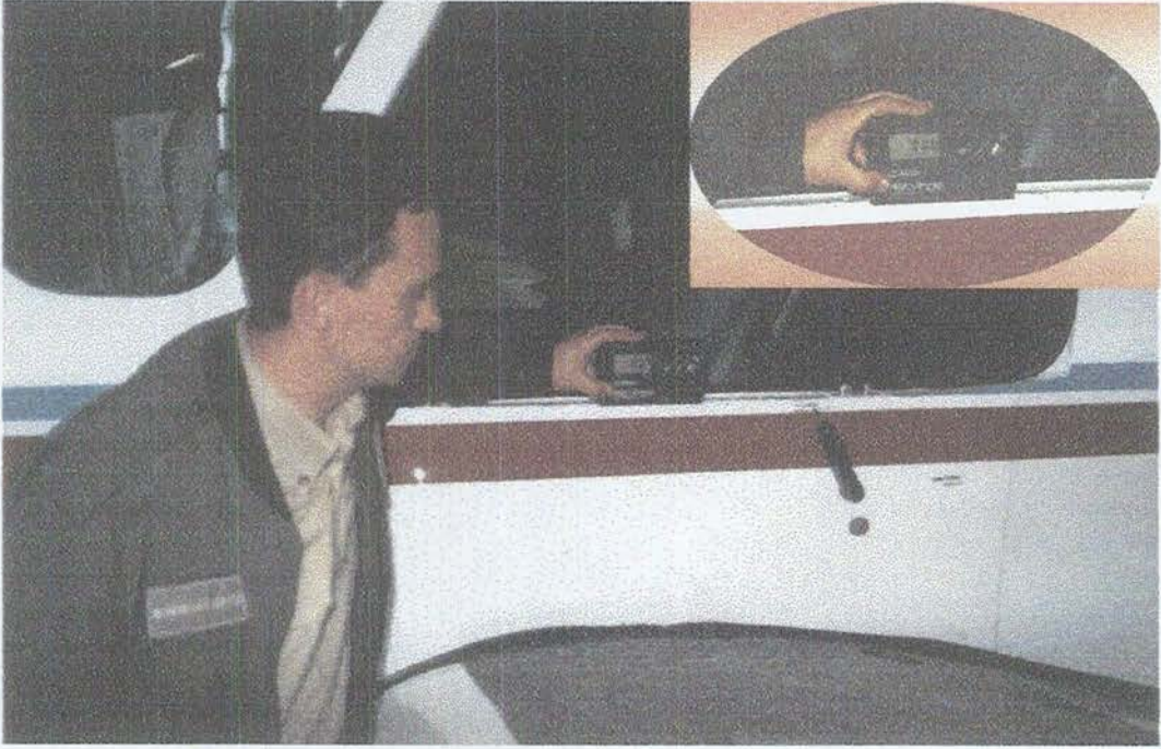
Şekil 4.6. Uçağın uzunlamasına ekseninde yatay durum ayarı.
