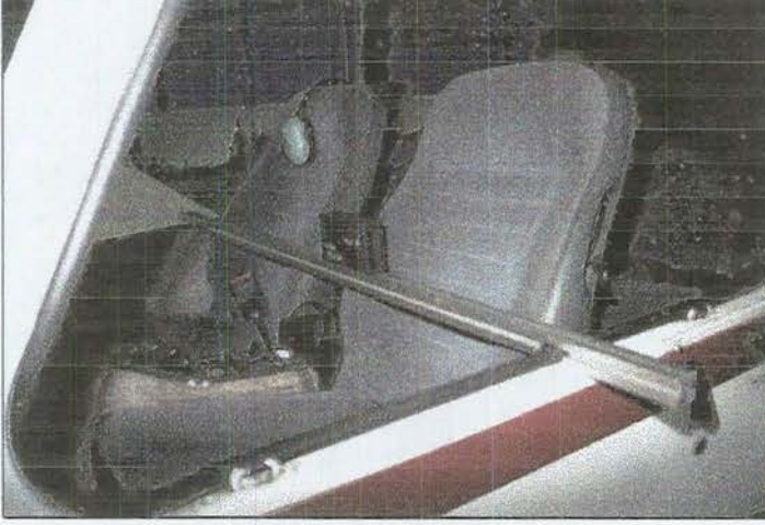
Şekil 6.12. Uçağın enine eksen yatay durum ayarı
