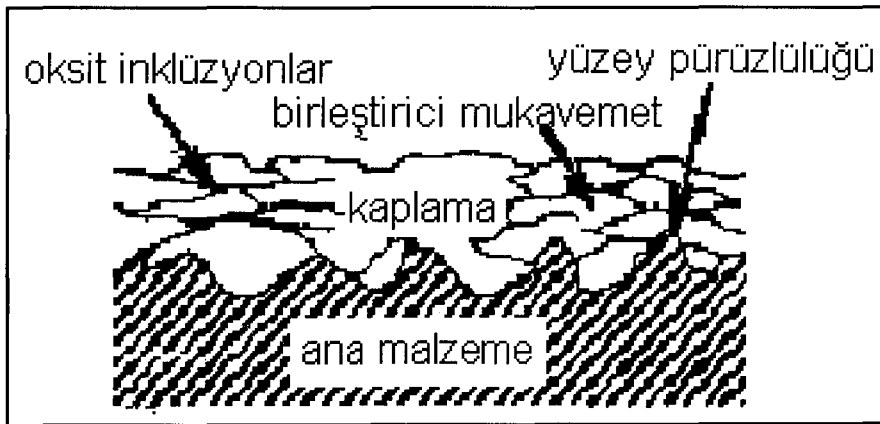
Şekil 3.1. Tipik bir termal spre y kaplama kesiti
