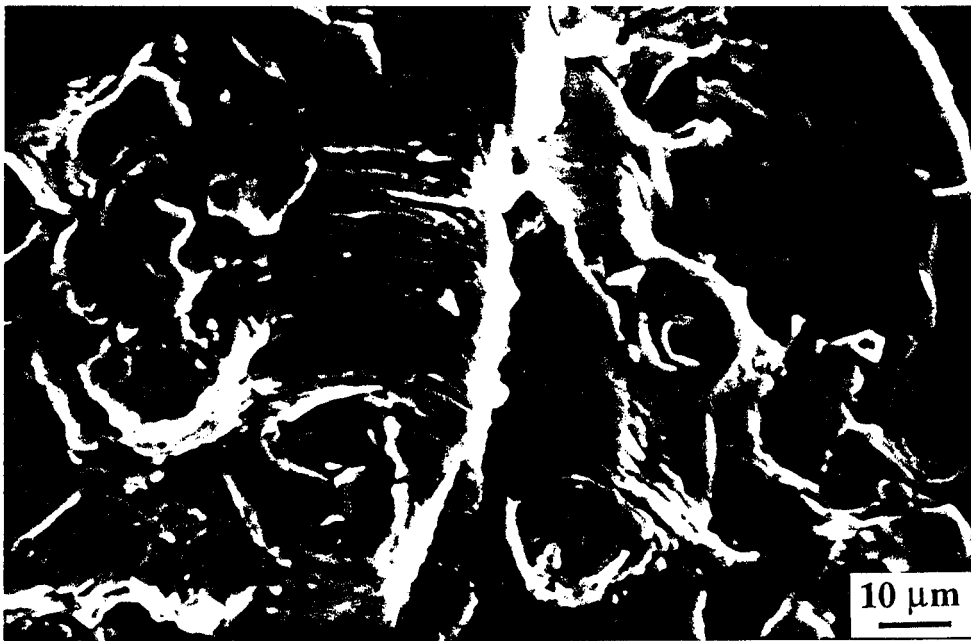
Şekil 6.38. R=0,1 oranında, Şekil 6.15'de değerleri verilen yükleme altında oluşmuş mikro boşluklar
