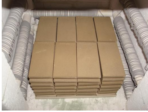
Şekil 3.8. Pres ile kuru şekillendirilmiş tabletler
