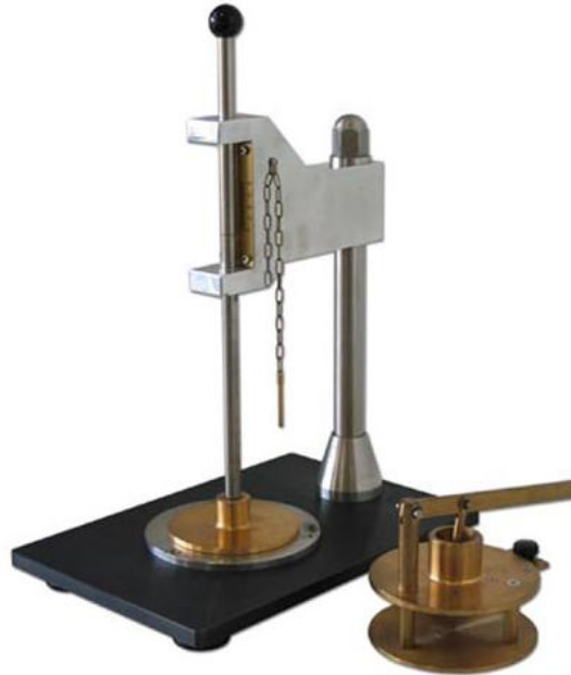
Şekil 3.10. Pfefferkorn test düzeneği (Anonim, 2015)
