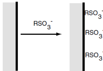
Şekil 6.4. Spesifik iyon adsorpsiyonu mekanizmasının şematik gösterimi (Myers 1999)
